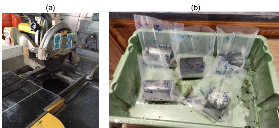
Figura III.2: Corte dos testemunhos de sondagem. (a) Rebarbadora (b) Tarolos
