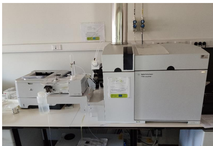
Figura III.5: Espectrómetro de massa por plasma acoplado indutivamente (ICP-MS).
