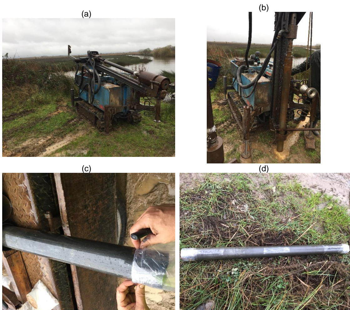
Figura III.1: Amostragem. (a) e (b) Equipamento de sondagem; (c) e (d) tubos de recolha de sedimentos
