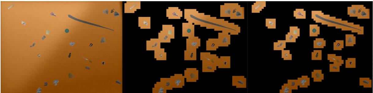
**Figura 6.16:** Exemplo de uma boa detecção com GMM, usando um bloco de 16 x 16 com critério produto, num chão do laranja. Imagem original, classificação usando GMM probabilidade e GMM previsão, respetivamente.
