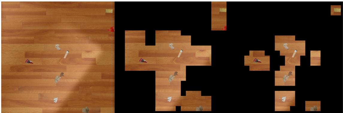
**Figura A.18:** Detecção fraca em chão de madeira com bloco 64 x 64 e critério produto.
