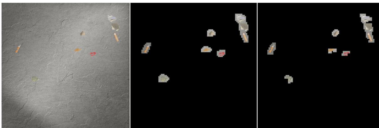
**Figura 6.14:** Exemplo de uma boa deteção com GMM, usando um bloco de 16 x 16 com critério maioritário, num chão do cimento. Imagem original, classificação usando GMM probabilidade e GMM previsão, respetivamente.
