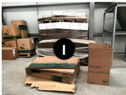
Figura 20 – A: obstrução do quadro elétrico; B: obstrução do carretel; C: uso da área para arrumação de encomendas acabadas; D: paletes com mais de 1000 kg arrumadas na estante; E: material fora da sua localização; F: deformação na parede do armazém; G: identificadores não uniformizados ou ausentes; H: estante fora da sua área; I: caixas armazenadas no chão; J: materiais de difícil acesso.
