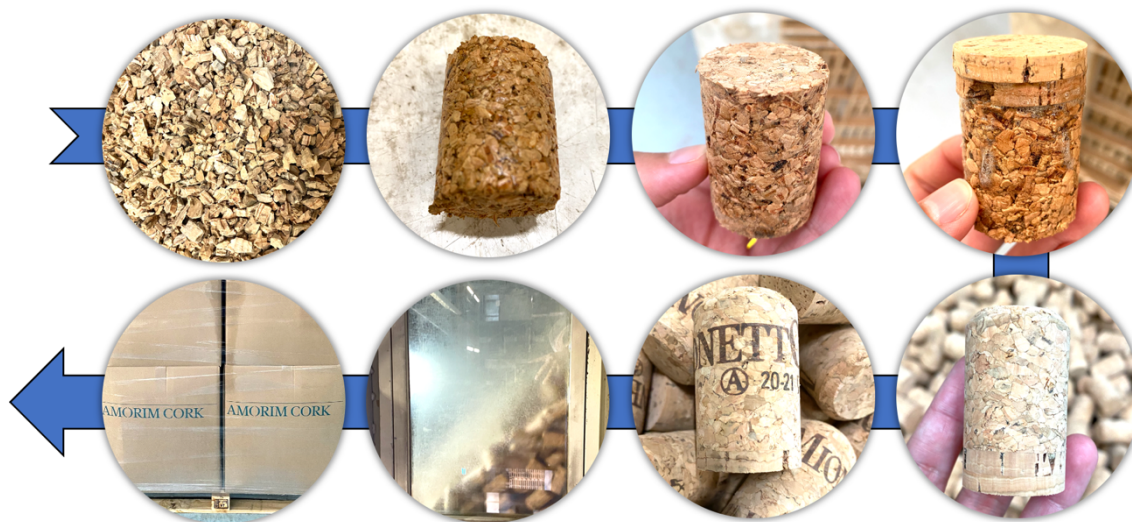
Figura 1 - Esquema ilustrativo das fases de transformação a que o produto é sujeito.
