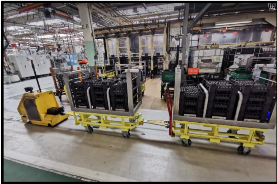
Figura 36 - Cargas já granalhadas a ser transportadas por AGV
