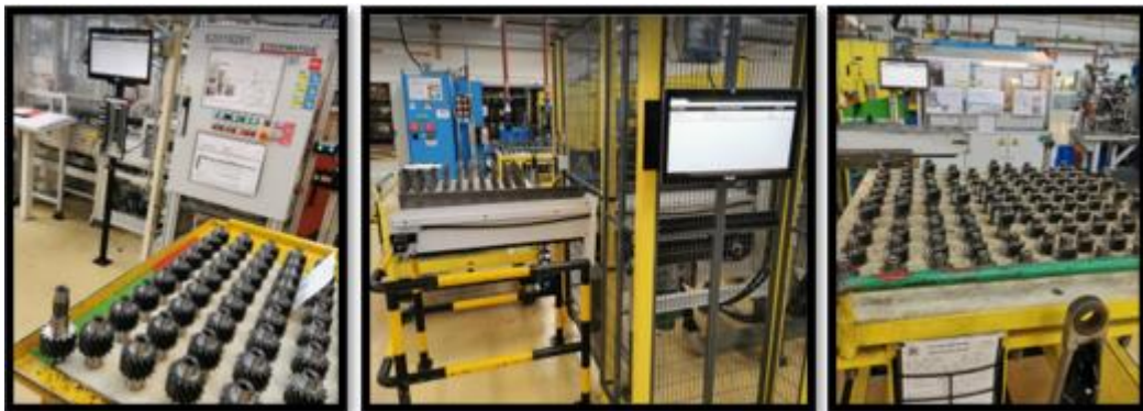
Figura 37 - Tablets no início das linhas de retificação das árvores
