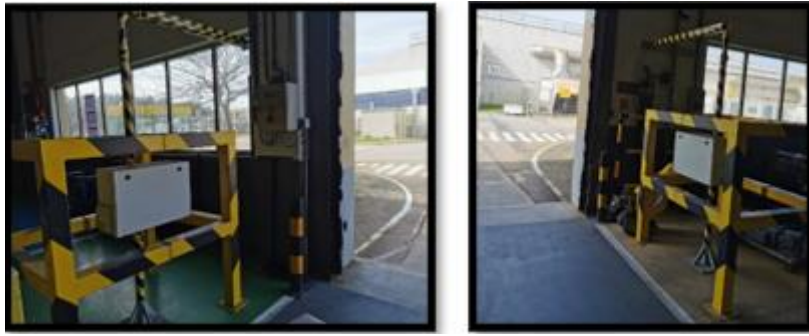
Figura 58 - Pórtico para leitura de RFID's
