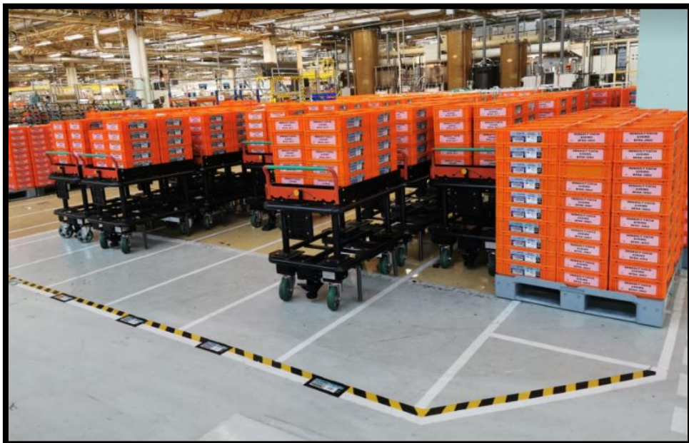
Figura 40 - Zona de Stock do Produto Acabado alargada (Depois)
