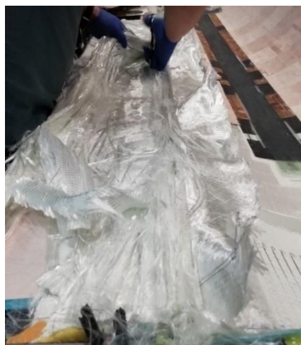
Figura 25: Corte de fibra seca layup externo
