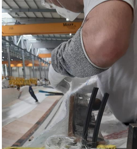
Figura 26: Calha para sobreposição de fibras layup interno
