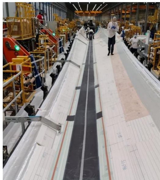
Figura 23: Colocação da Cap com auxílio do distanciador
