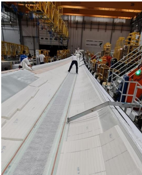
Figura 22: Posicionamento de distanciador para colocação da Cap
