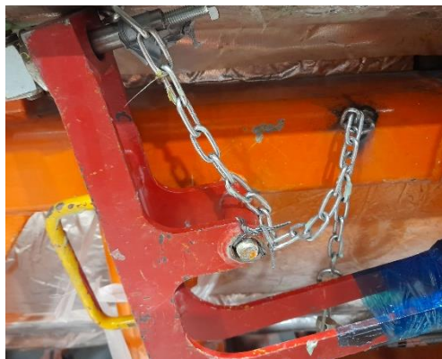
Figura 45: Aprisionamento de grampos no molde
