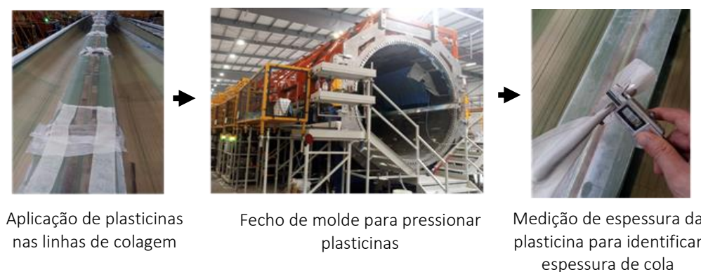
Figura 52: Teste seco para validar Colagem
