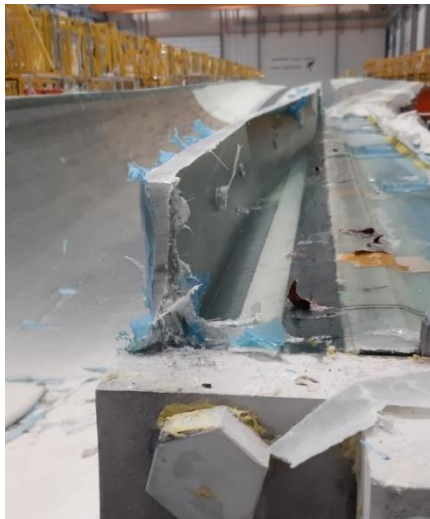
Figura 27: Excedente de material aprisionado na calha
