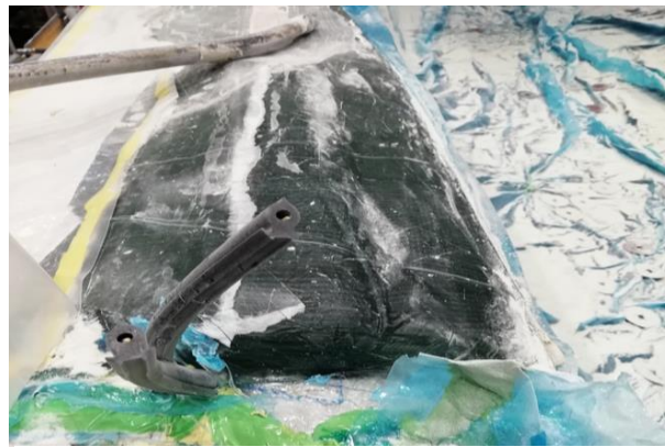
Figura 24: Material em excesso na aba do molde
