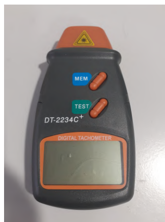
Figura 4.2: Tacómetro utilizado na medição das RPM.
