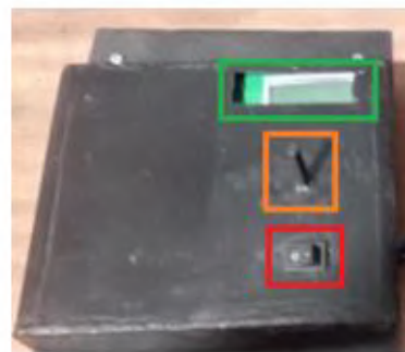
Figura 2-Sistema de comando (Verde- LCD; Laranja-potenciómetro; vermelho-botão de start).
