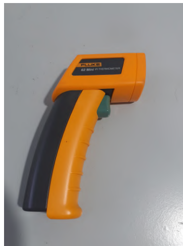
Figura 4.3: Pirómetro utilizado na medição da temperatura.
