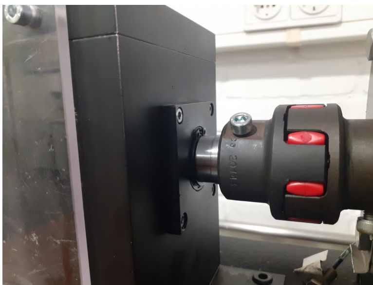
Figura 4.6: Imagem demonstrativa do eixo depois de montado já com o anel elástico.
