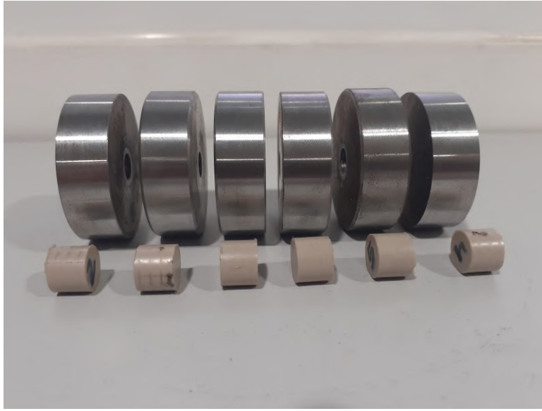
Figura 4.11: Estado das amostras e respetivos discos após a submissão dos ensaios.
