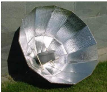
Figura 2.10: Cozinha solar do tipo duplo
