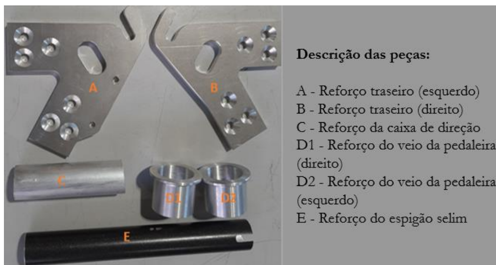
Figura 7.2 - Partes metálicas fabricadas em alumínio 6061-T6
