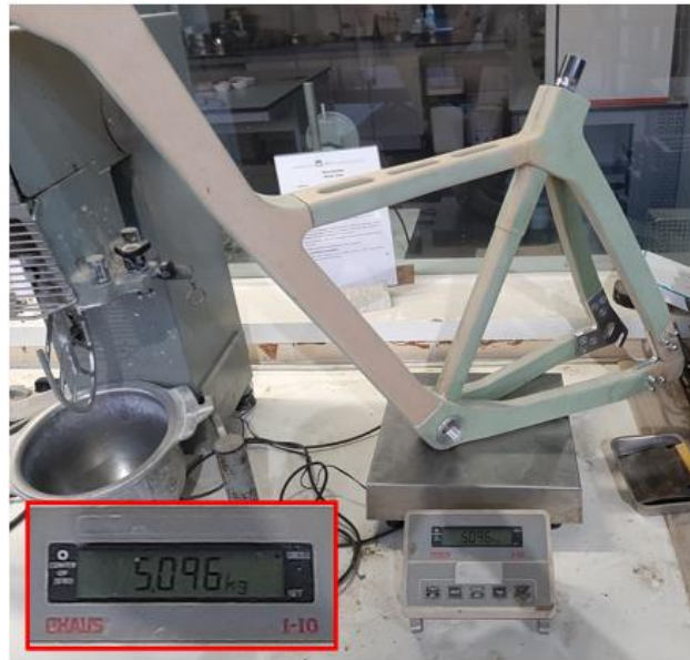
Figura 7.8 - Medição da massa do protótipo
