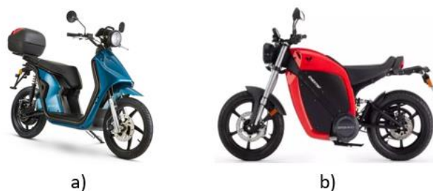
Figura 2.6 - a) Scooter elétrica GOVECS FLEX [25], b) Motocicleta elétrica Brammo Enertia Plus (adaptado de [25])
