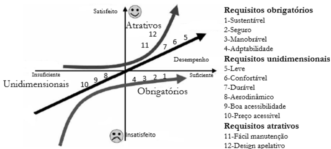
Figura 5.3 - Diagrama de Kano e classificação dos requisitos do quadro
