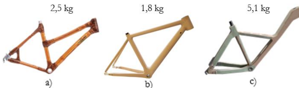
Figura 7.9 -Valores de massa para diferentes quadros com a utilização de materiais naturais: a) quadro de bambu [41]; b) quadro de madeira; c) protótipo em MDF
