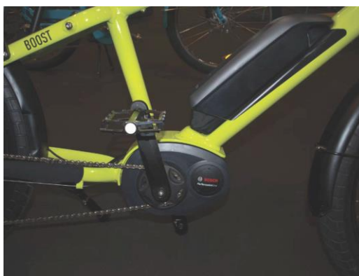
Figura 2.10 - Motor elétrico instalado em conjunto com o eixo da pedaleira (adaptado de [31])
