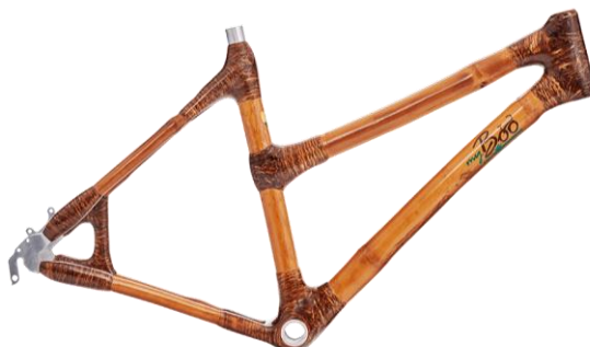
Figura 2.13 - Quadro em bambu desenvolvido pela empresa My Boo (adaptado de [41])
