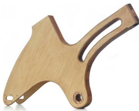
Figura 2.16 - Protótipo de quadro em contraplacado designado por Xylon (adaptado de [32])
