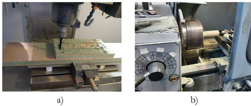
Figura 7.4 - Fabrico dos componentes em MDF: a) Maquinação CNC do bloco da secção intermédia; b) Maquinação da secção do tubo do selim no torno paralelo
