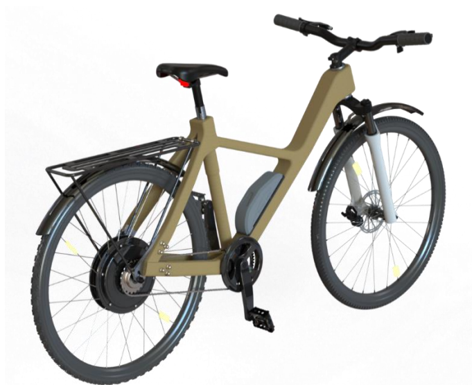
Figura 6.1 - Quadro proposto com integrado na bicicleta elétrica
