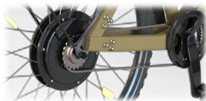
Figura 6.2 - Sistema de transmissão de uma mudança
