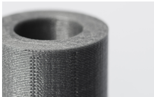
Figura 2.4: Ilustração das diferentes camadas em produto obtido por FDM [5]
