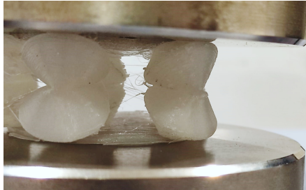
Figura 4.8: Resultado do teste de compressão para o material nylon
