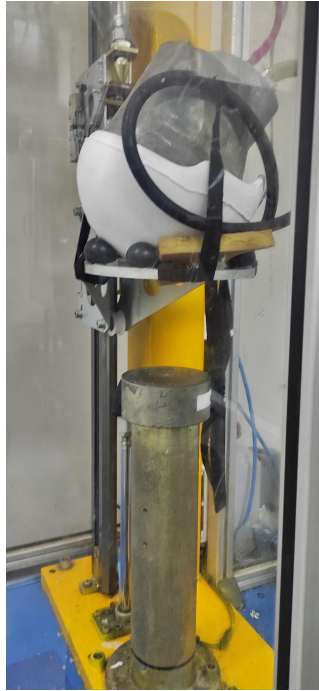
Figura 6.1: Ilustração do mecanismo utilizado para realização dos testes experimentais
