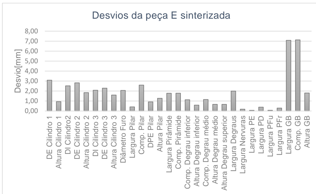
Figura 38 - Desvios ocorridos na peça E sinterizada em relação ao modelo menor.
