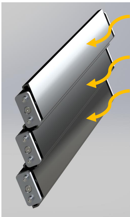
Figura 29: Renderização da posição de três lamelas durante a fase de armazenamento de energia exterior por parte do PCM
