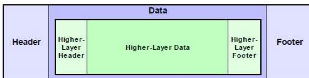
Figura 2: Esquema de mensagem TCP/IP, [7].
