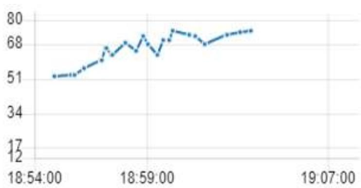
Figura 21: Evolução temporal da temperatura do compressor.
