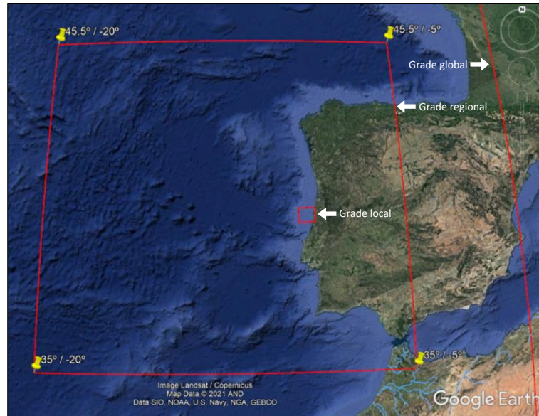
Figura 2. Limites de domínio da grade regional (coordenadas em graus decimais), o quadrante menor representa a grade local aninhada na grade regional. A linha vermelha na extremidade direita da figura representa o limite mais a leste da grade global.
