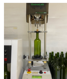
Figura 76: Máquina da força de extração em movimento.
