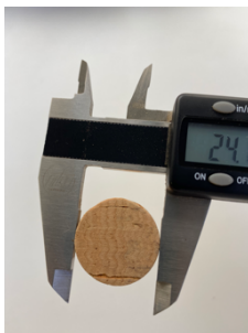
Figura 51: Medição referente a d_1 , com os anéis de crescimento paralelos às hastes do paquímetro.
