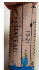
Figura 64: Resultado do ensaio da capilaridade com progressão externa.
