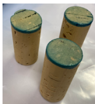
Figura 63: Resultado do ensaio da capilaridade sem progressão externa.
