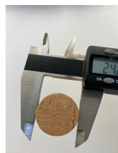
Figura 52: Medição referente a d_2 com os anéis de crescimento na perpendicular em relação às hastes do paquímetro.
