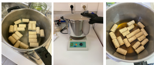
Figura 71: Ensaio de resistência à água fervente.
