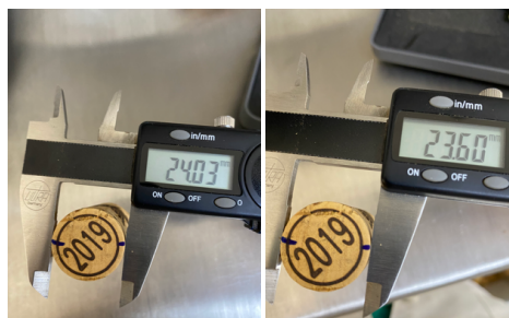
Figura 73: Ensaio de recuperação dimensional.
