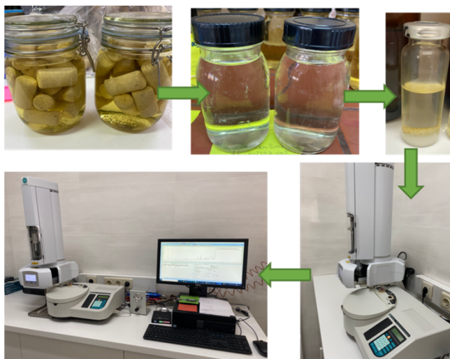
Figura 58: Esquema de como se efetua o ensaio da quantificação dos cloroanisóis.
