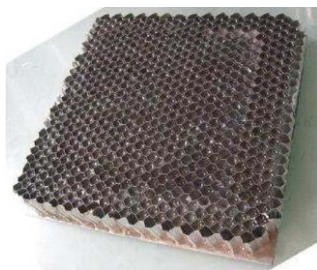
Figura 3.19 PCM macroencapsulado sob a forma de favos [77].
