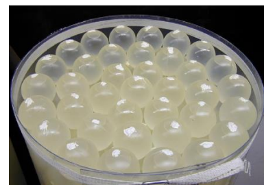
Figura 3.20 PCM macroencapsulado sob a forma de esferas [78].
