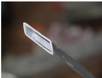
Figura 3.16 PCM macroencapsulado em ripas de alumínio [25].
