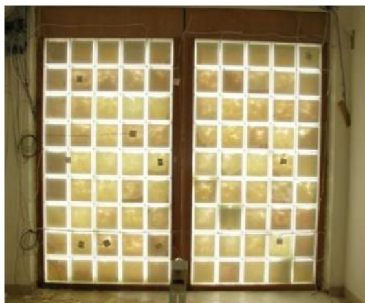
Figura 3.21 PCM macroencapsulado em blocos translúcidos, TIM-PCM [23].
