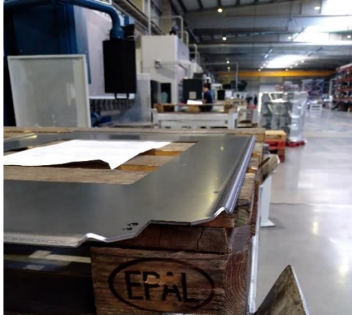
Figura 26 - Perfil obtido para alocar o cordão de vedação da porta.
