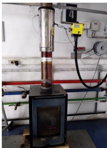
Figura 35 - Preparação do protótipo para ensaio laboratorial conforme indicado pela norma EN16510-1
