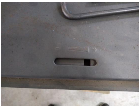
Figura 3 - Regulador do ar para o varrimento do vidro do recuperador Bosca Eco 380
