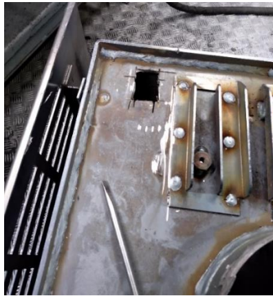
Figura 42 - Abertura de uma segunda entrada para fornecimento de ar para o varrimento do vidro.
