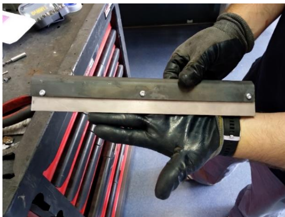
Figura 38 - Alteração efetuada na defletora do vidro. Aumento de 30mm.
