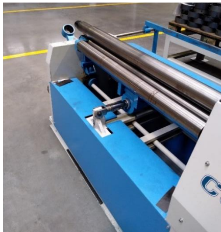
Figura 15 - Calandra. Chão de fábrica Solzaima.
