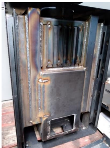
Figura 43 - Configuração final da câmara de combustão após a colocação do segundo canal.
