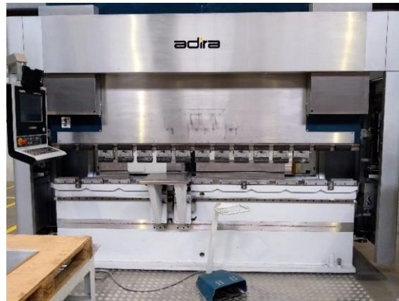
Figura 13 - Quinadora Adira. Chão de fábrica Solzaima.
