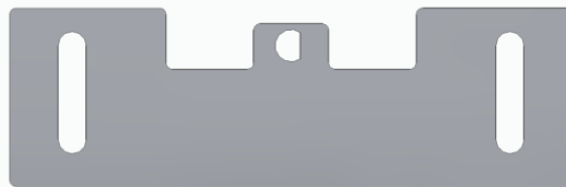
Figura 36 - Nova chapa para regular a abertura da entrada de ar para a combustão secundária
