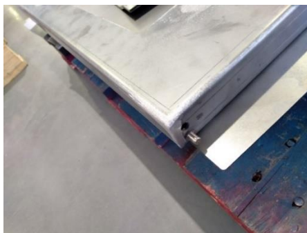
Figura 28 - Pino para guia da rotação da porta
