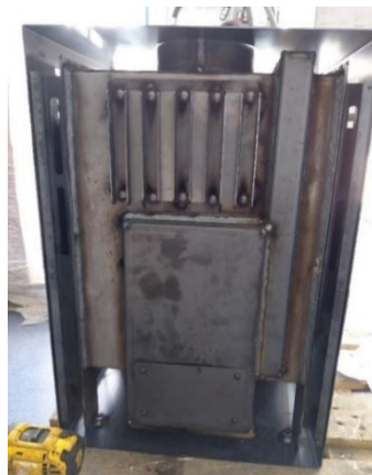
Figura 40 - Câmara de combustão antes da colocação do segundo canal.
