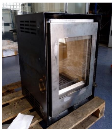
Figura 30 - Protótipo do recuperador de calor desenvolvido
