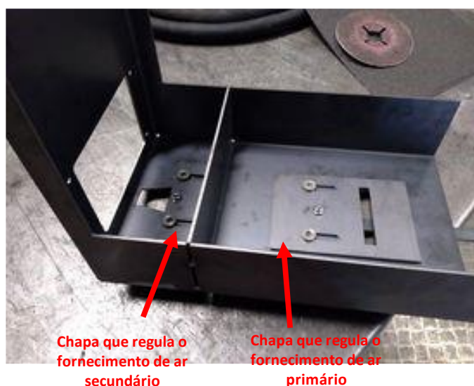
Figura 24 - Maquete do mecanismo de regulação das entradas de ar.
