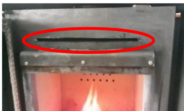
Figura 44 - Alargamento da área de passagem da área para o varrimento do vidro.
