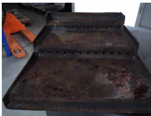
Figura 2 - Defletora de fumos metálica e oca do recuperador Bosca Eco 380.
