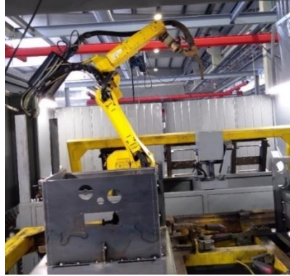
Figura 17 - Robot de soldadura. Chão de fábrica da Solzaima.
