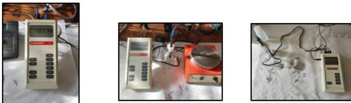
Figura 20 - Aparelhos utilizados nas leituras do pH, oxigénio dissolvido e condutividade das amostras, respetivamente
