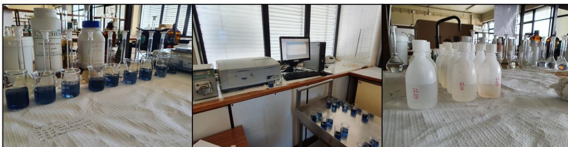
Figura 24 - Da esquerda para a direita: coloração das amostras após digestão e após adição de reagente combinado; espectrofotômetro de absorção atômica a partir do qual foram realizadas as leituras relativamente à quantificação de fósforo; preservação das amostras após o processo de digestão que foram utilizadas posteriormente na quantificação de metais
