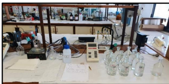
Figura 21 - Organização da bancada de trabalho durante as leituras da carência bioquímica de oxigénio
