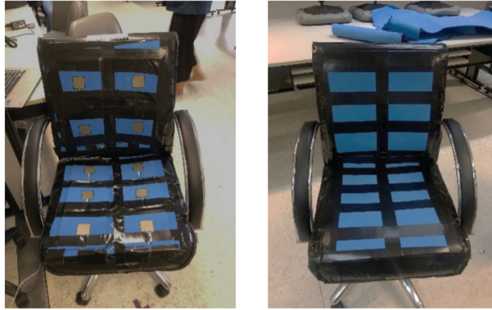
Figura 2.2: Cadeira ergonómica com um mapa de pressão baseado em sensores de força resistivo [14]
