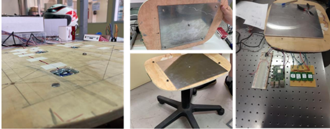
Figura 3.5: Fotografias representativas do sistema (da esquerda para a direita): Sensores instalados no assento da cadeira, chapas de alumínio superior e inferior, e sistema de instrumentação para a aquisição dos sensores do assento
