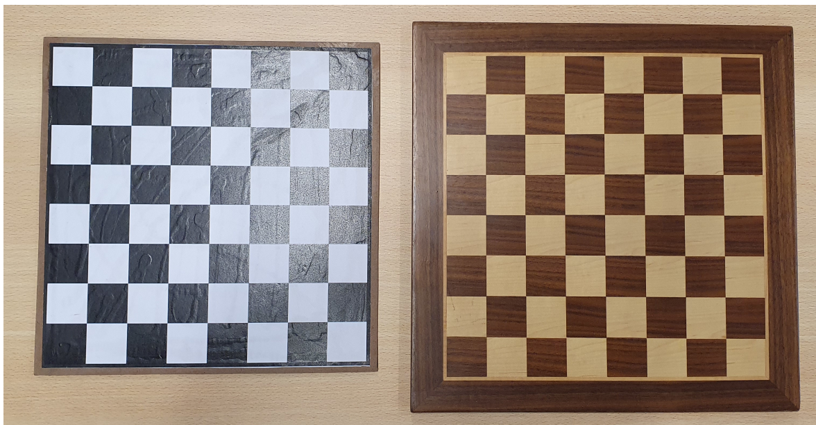
Figura 6.2: Tabuleiros usados para teste da deteção do tabuleiro. O tabuleiro da esquerda foi impresso em papel e apresenta melhor contraste entre os quadrados, enquanto que o da direita representa o tabuleiro tradicional feito de madeira.
