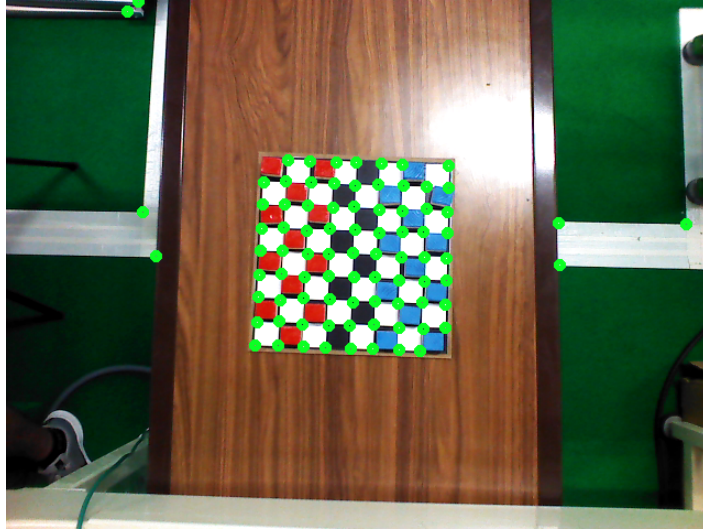
Figura 4.7: Cada círculo verde corresponde a um cantos retornado pela função goodFeaturesToTrack() sobreposto na imagem inicial.
