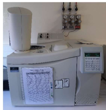
Figura 12 - Cromatógrafo de GC-FID utilizado na determinação do teor de açúcares
