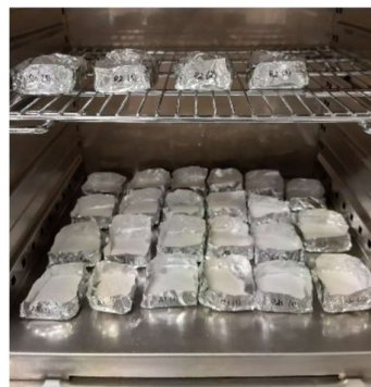
Figura 10 – Amostras de farinha de arroz na estufa para a determinação da humidade
