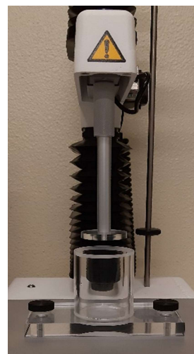
Figura 17 – Sonda de compressão usada na análise de TPA
