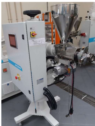
Figura 19 – Extrusora utilizada nos ensaios de extrusão de farinha de arroz
