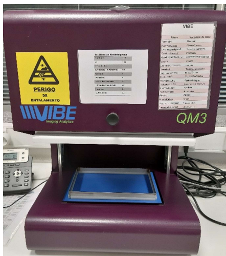
Figura 9 - Equipamento VIBE para análise de dimensões e cores de amostras de arroz
