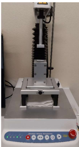
Figura 15 – Texturómetro com sonda de extrusão de arroz
