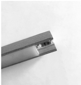
F74 Solução para aplicar fitas LED imagem da autora
