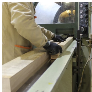
F99 Molduradora para calibrar imagem da autora
