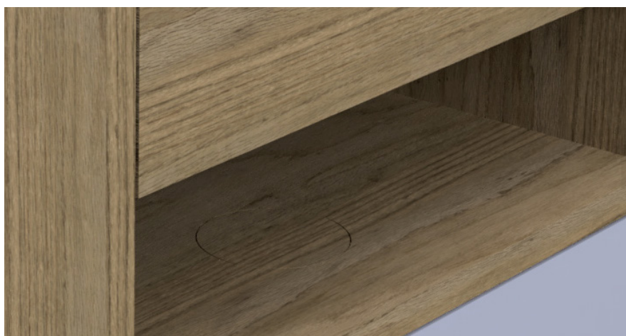
F81 Detalhe da sinalização do carregamento imagem da autora
