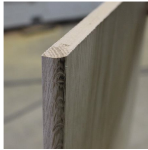
F122 Boleados resultantes do encabeçamento imagem da autora
