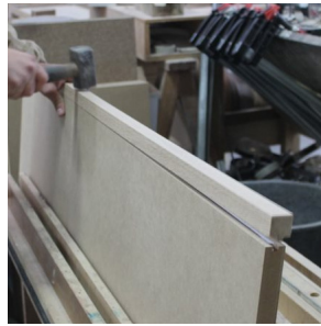
F110 Processo de encabeçamento imagem da autora
