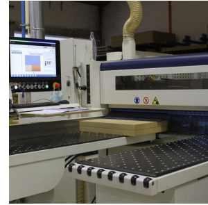
F107 Corte do mdf na seccionadora imagem da autora
