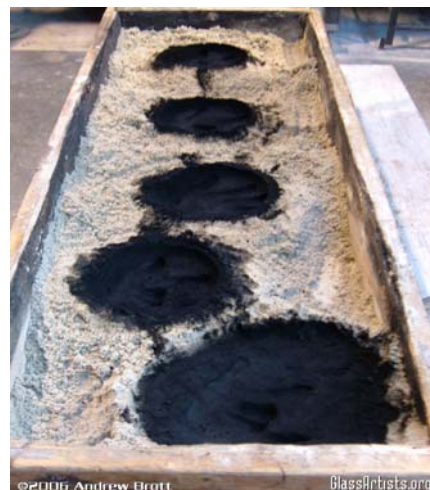
Fig. 103 – Cofragem de areia preparada para receber o vidro fundido.
