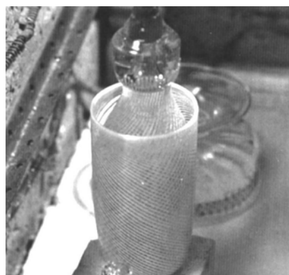
Fig. 124 - Vetro a fili . O vidreiro sopra um cilindro dentro de outro criando filamentos cruzados. Fonte: (Tait, 1995: 238)
