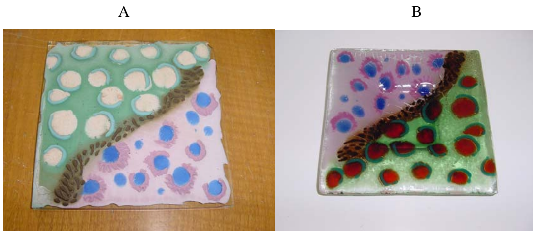
Fig. 180 – Aplicação de pasta de vidro sobre uma lâmina float (A). Resultado após cumprir a curva de cozedura para vidro float (B).
