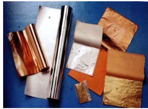
Fig. 170 – Folhas metálicas: alumínio, ouro, cobre, estanho. Fonte: (Beveridge, 2004: 39)
