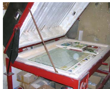
Fig.161 - Forno de vitrofusão do tipo arca. Fonte: (Beveridge, 2004: 49)
