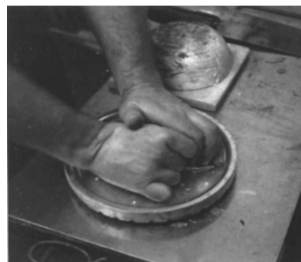
Fig. 110 – O vidro é prensado contra a mesa com a ajuda de um molde.
