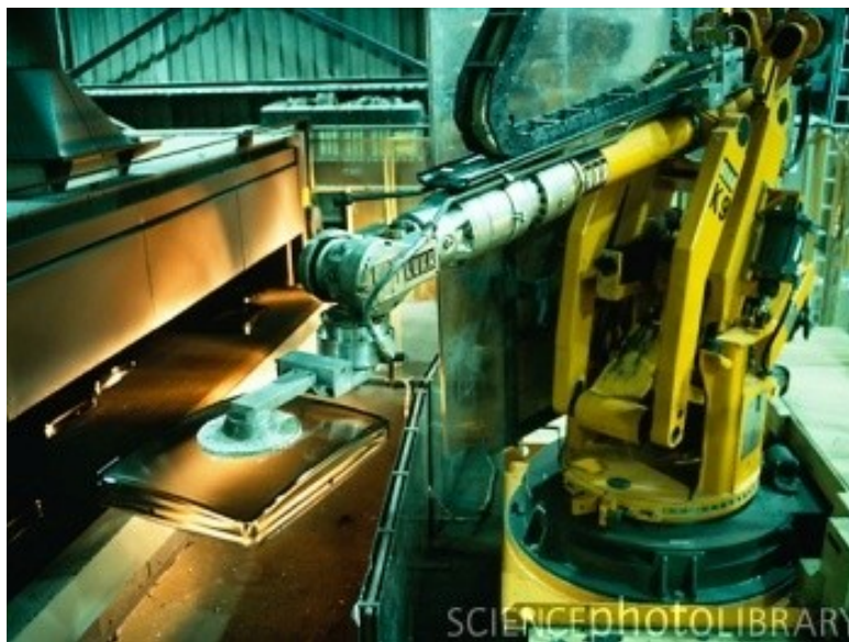
Fig. 73 - Braço robótico retira da arca de recozimento um vidro para ecrã de televisão. Fonte: http://www.sciencephoto.com
