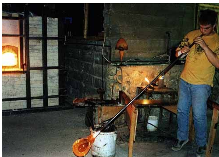
Fig. 115 – O soprador de vidro, insufla ar na massa vítrea à medida que dá a forma ao objecto. Fonte: http://claude.fourcaulx.free.fr
