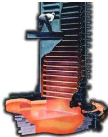
Fig 89 – Processo Pennvernon de fabricação do vidro plano. Fonte: http://www.glasslinks.com/trivia/pennvernon.htm
