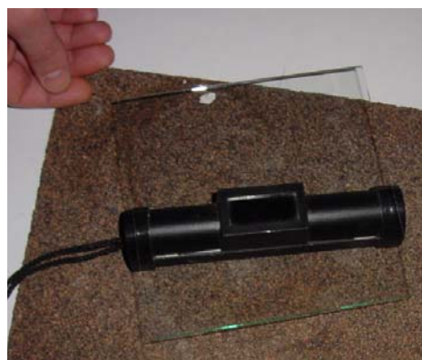
Fig. 158 – Identificação do lado estanhado do vidro float através da exposição à lâmpada UV.
