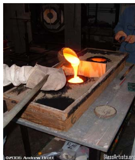
Fig. 104 – Sand casting. Vidro é vertido numa cofragem de areia. Fonte: http://www.glassartists.org
