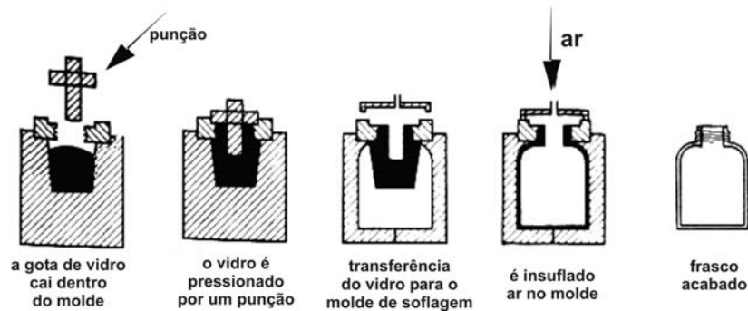
Fig.76 – processo de fabricação do vidro por prensagem e soflagem. Fonte: (Holloway, 1973: xi)
