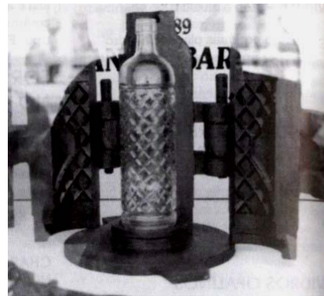
Fig. 113 – Molde de garrafa em ferro fundido. Fonte: APAI (1989)
