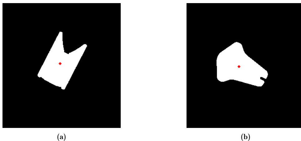
Figura 5.28 – Cálculo aproximado da área da peça. O ponto vermelho representa o centróide.
