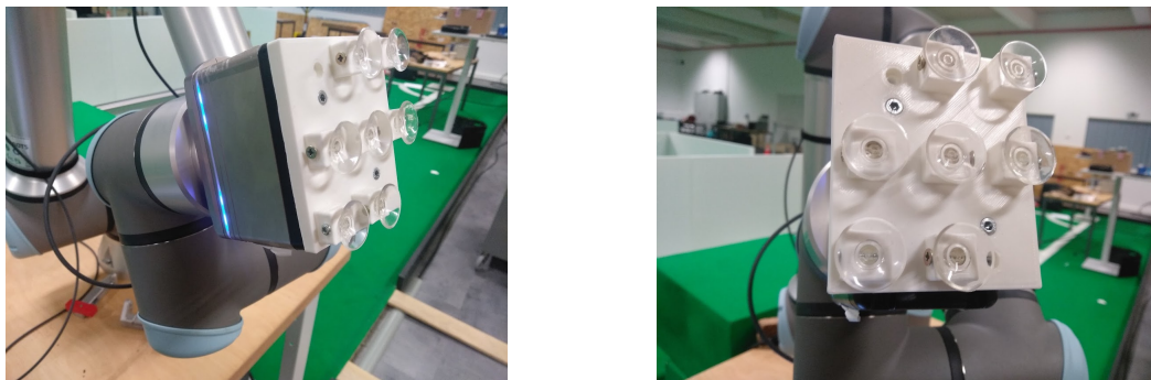
Figura 6.11 – Protótipo da garra a vácuo com 7 ventosas de 22mm de diâmetro.
