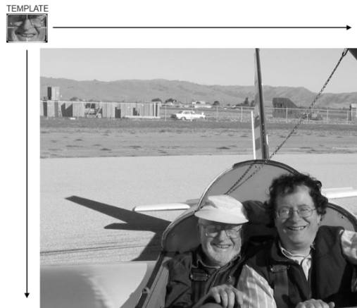
Figura 2.7 – Processo de correspondências baseado numa imagem modelo que percorre toda a imagem original [6].
