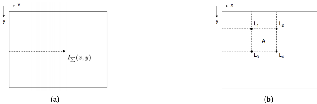
Figura 2.13 – Representação da imagem integral à esquerda e calculo da área A usando uma imagem integral à direita: A = L_4 + L_1 - L_2 - L_3 .
