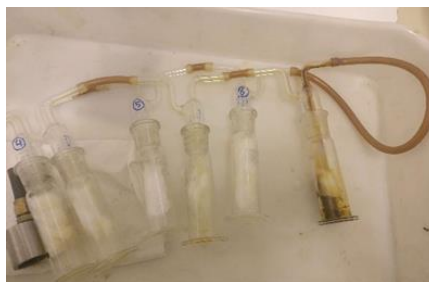
Figura 14 – Sistema de condensadores
