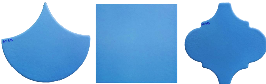
Figura 42 - Peças vidradas com a mistura de 6% em massa do pigmento EB8 e vidro V2 e cozidas a 900 °C.
