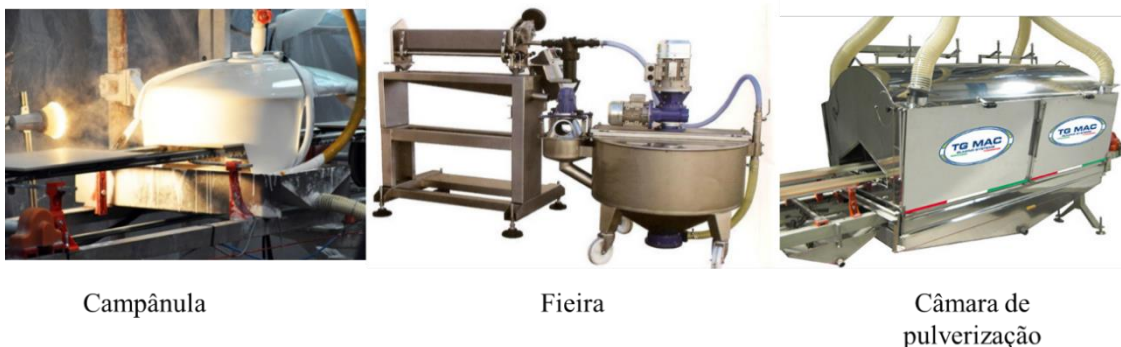
Figura 6- Alguns dos principais métodos de aplicação de vidrados em suspensão [6].
