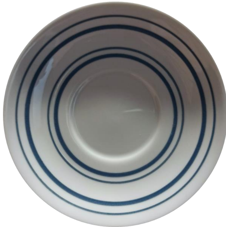
Figura 44 - Peça em porcelana com filetes aplicados utilizando tinta preparada com pigmento EB8 e vidrado V2 e cozida a 900 °C.
