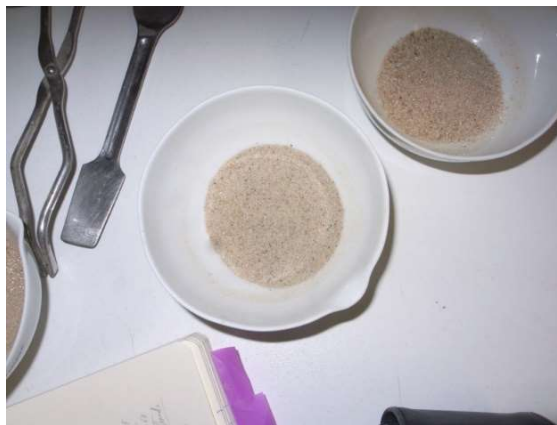
Fig.20: Material depois de lavado e seco, pronto para peneiração.
