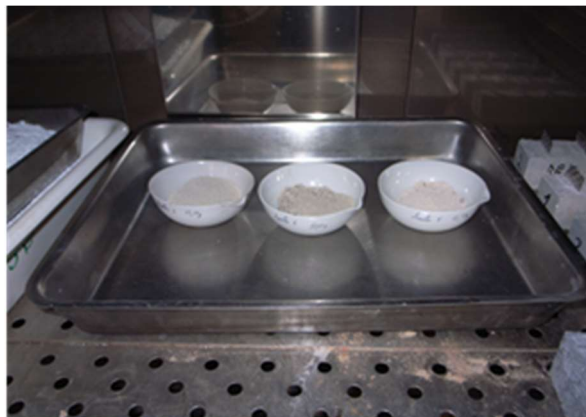
Fig.15: Amostras no forno a 100 °C.
