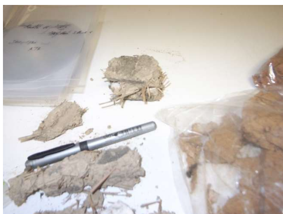
Fig.35: Amostra de argamassa terra/palha. Fig.36: Palha após a remoção da argamassa.
