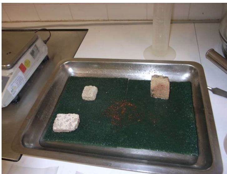
Fig.30: Ensaio a decorrer, onde se pode ver as amostras durante a absorção de água.
