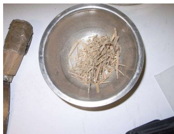
Fig.35: Amostra de argamassa terra/palha. Fig.36: Palha após a remoção da argamassa.
