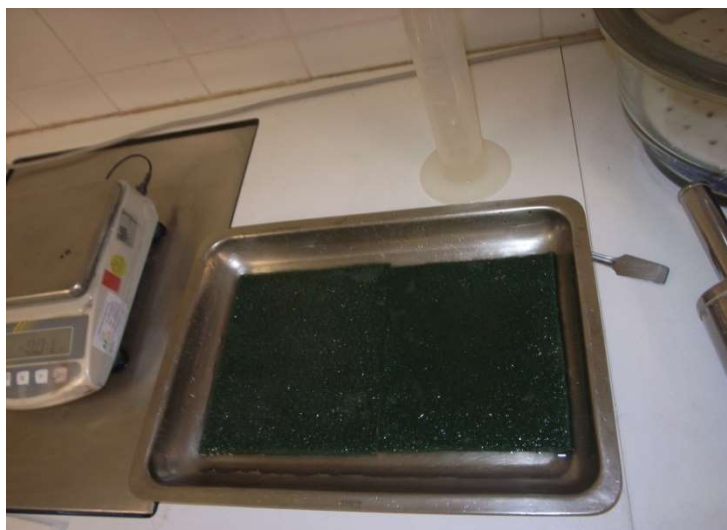
Fig.29: Tabuleiro com água pronto para os ensaios de absorção de água.
