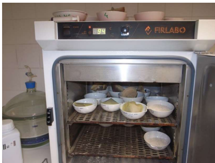
Fig.19: Secagem do material retido nos filtros.
