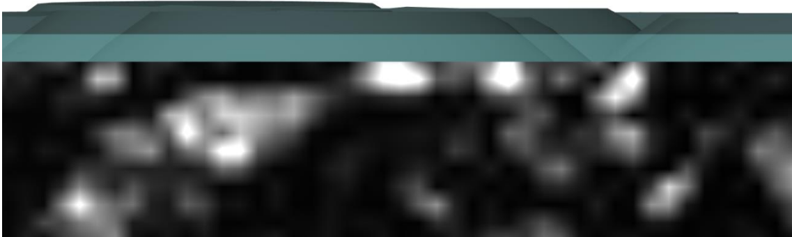
Figura 58 - Vista aproximada dos cabeços do agregado com desgaste e uma película de água a 50 % da macrotextura na mistura BB
