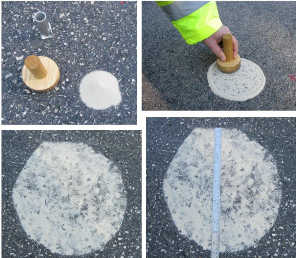
Figura 24 – Procedimento para a realização do ensaio mancha de areia
