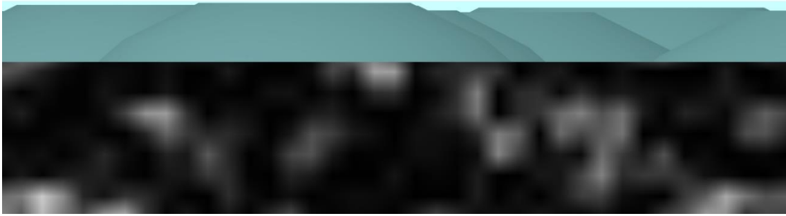
Figura 98 - Corte do modelo BBD com desgaste de 0,3 mm e com MTD = 0,7 mm e uma película de água a 100% da macrotextura
