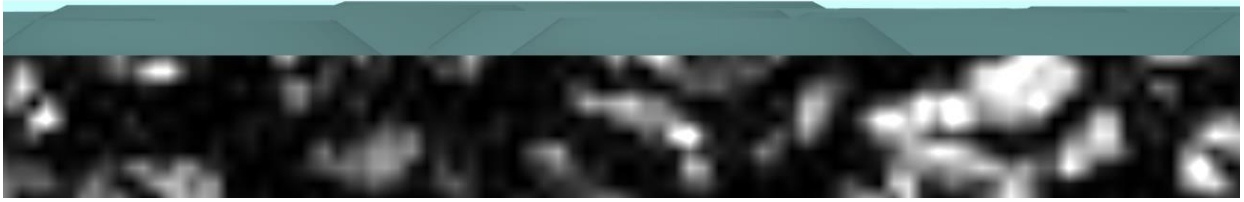
Figura 54 - Vista aproximada dos cabeços do agregado com desgaste e uma película de água a 10 % da macrotextura na mistura BB
