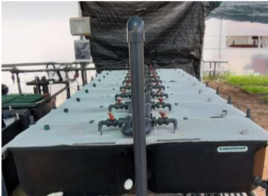
Figura 2: Tanques utilizados nos ensaios, cobertos por rede para evitar fugas.
