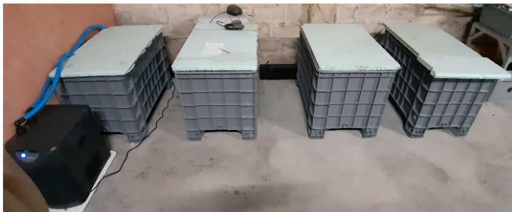
Figura 8 – Desenho experimental: quatro contentores com água do banho-maria (15, 20, 25 e 30 °C). Refrigerador na temperatura de 15 °C.
