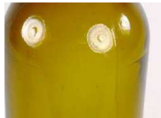
Figura 96 - Pormenor das linhas de junta Fonte - www.sha.org/bottle/body.htm
