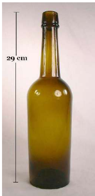
Figura 95 - Garrafa produzida com molde de quatro partes Fonte - www.sha.org/bottle/body.htm
