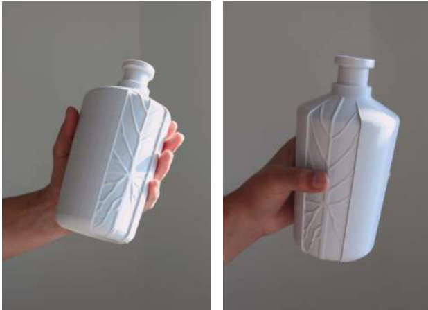
Figura 34 - Impressão do modelo em 3D
