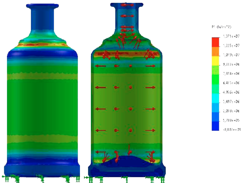
Figura 59 - Simulação de pressão interna no modelo 4 Fonte - Imagem da autora
