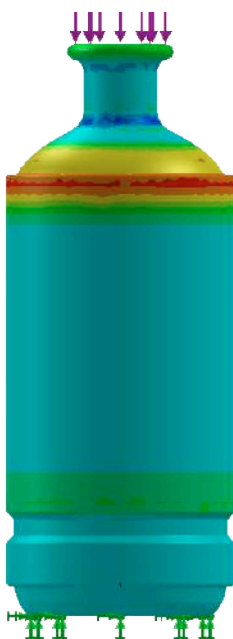
Figura 64 - Simulação de carga vertical no modelo 3 Fonte - Imagem da autora
