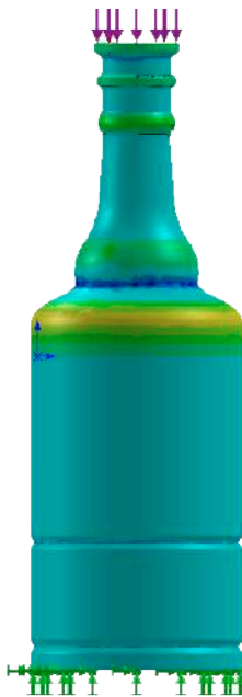
Figura 62 - Simulação de carga vertical no modelo 1 Fonte - Imagem da autora
