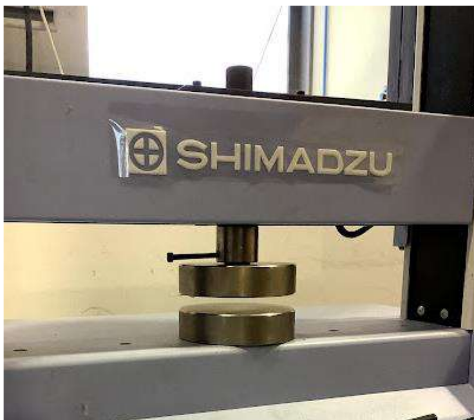
Fig. 117- máquina de teste com os “discos” de realização do ensaio de compressão (velocidade de 5mm/min)
