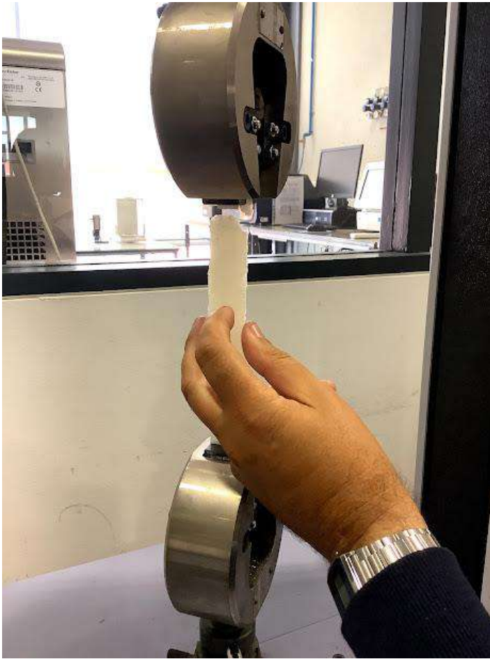
Fig. 109- detalhe com visualização das amarras afixadas a um provete (que sofreu fratura junto à amarra superior)
