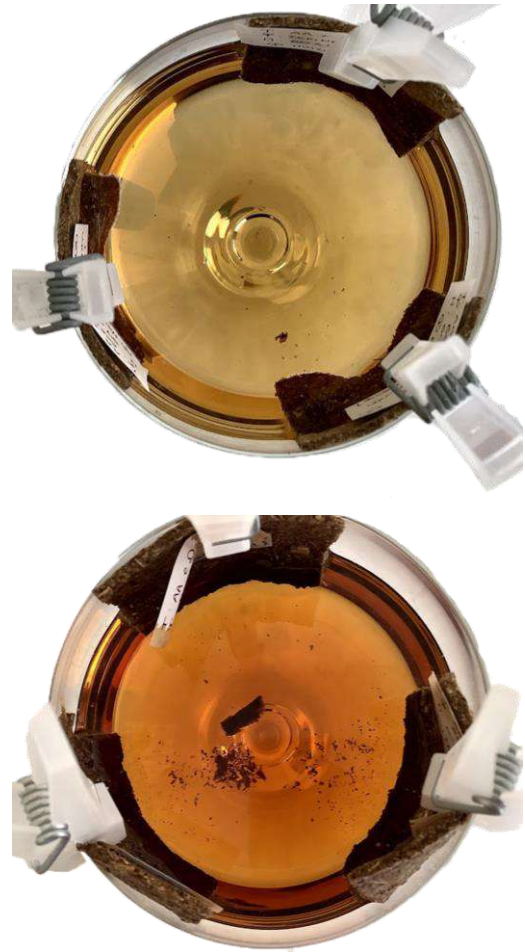
Fig. 96- apresentação dos resultados após o teste, sendo o primeiro recipiente dos provetes com mais amido de milho e o seguinte com menor quantidade de amido.
