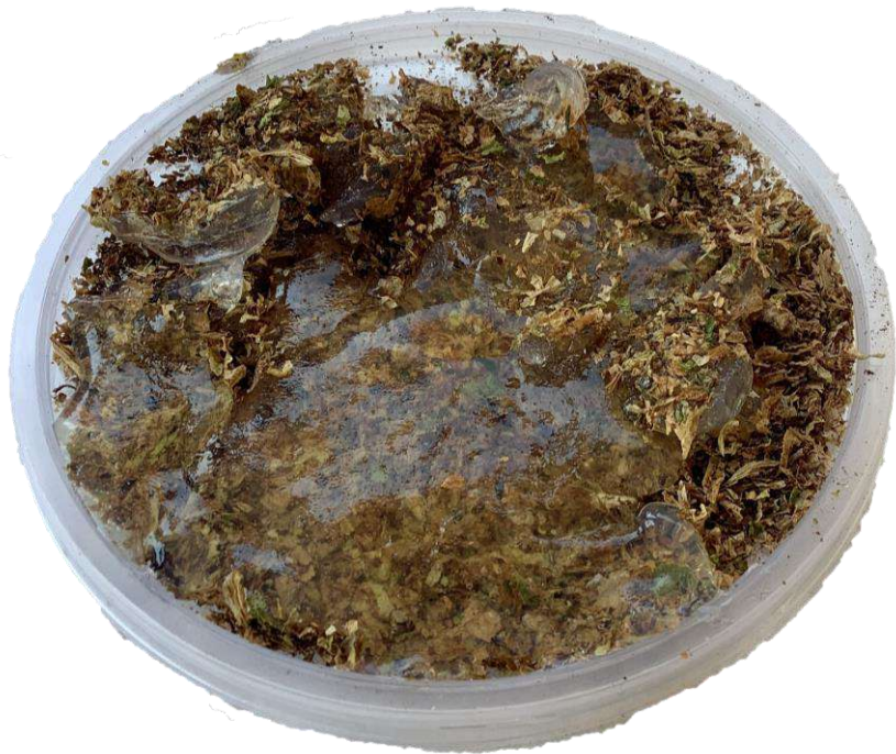
Fig. 49- amostra antes do processo de cura com zonas secas visíveis (aspeto de gelatina transparente)
