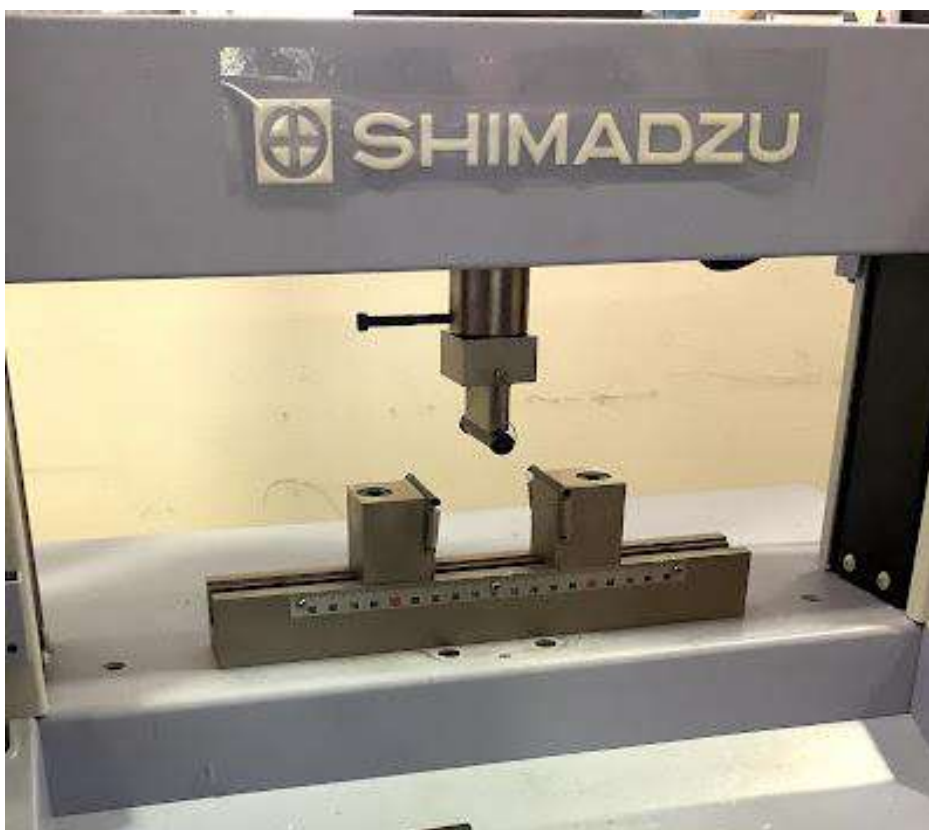
Fig. 113- máquina de teste com ferramentas de realização do ensaio de flexão (velocidade de 2mm/min)
