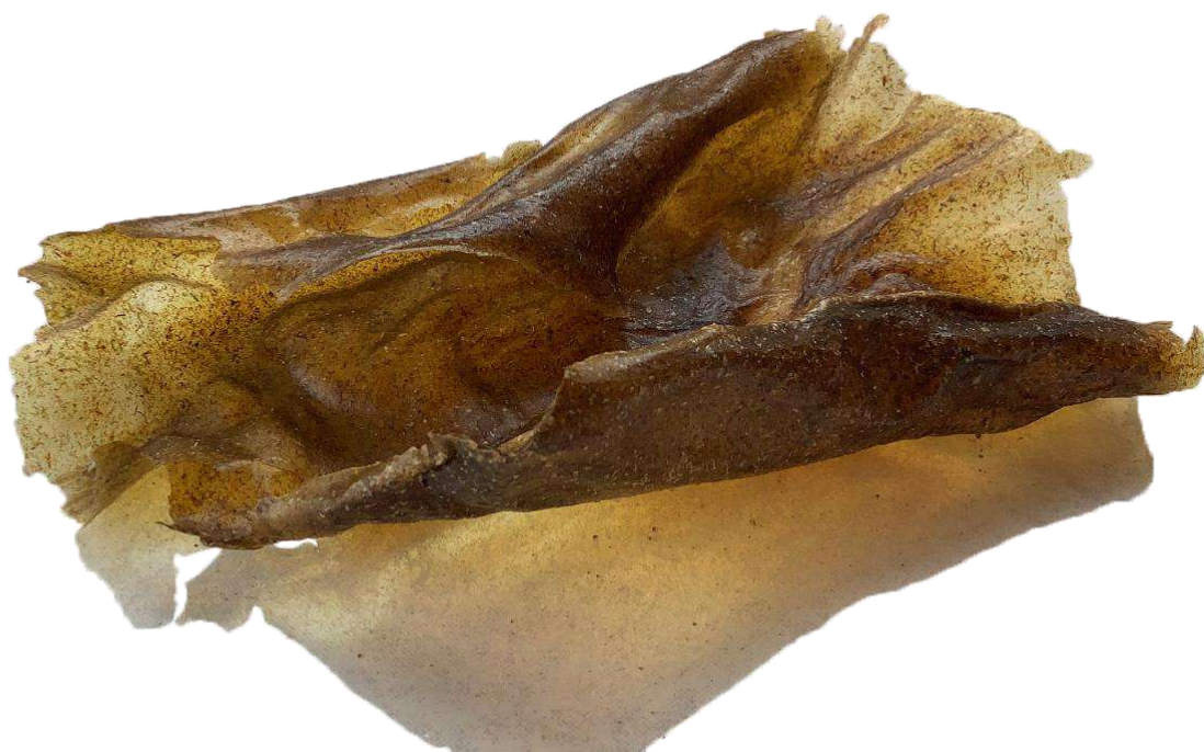
Fig. 34- amostra resultante da receita base #1 com fibras trituradas de alface semi-seca.
