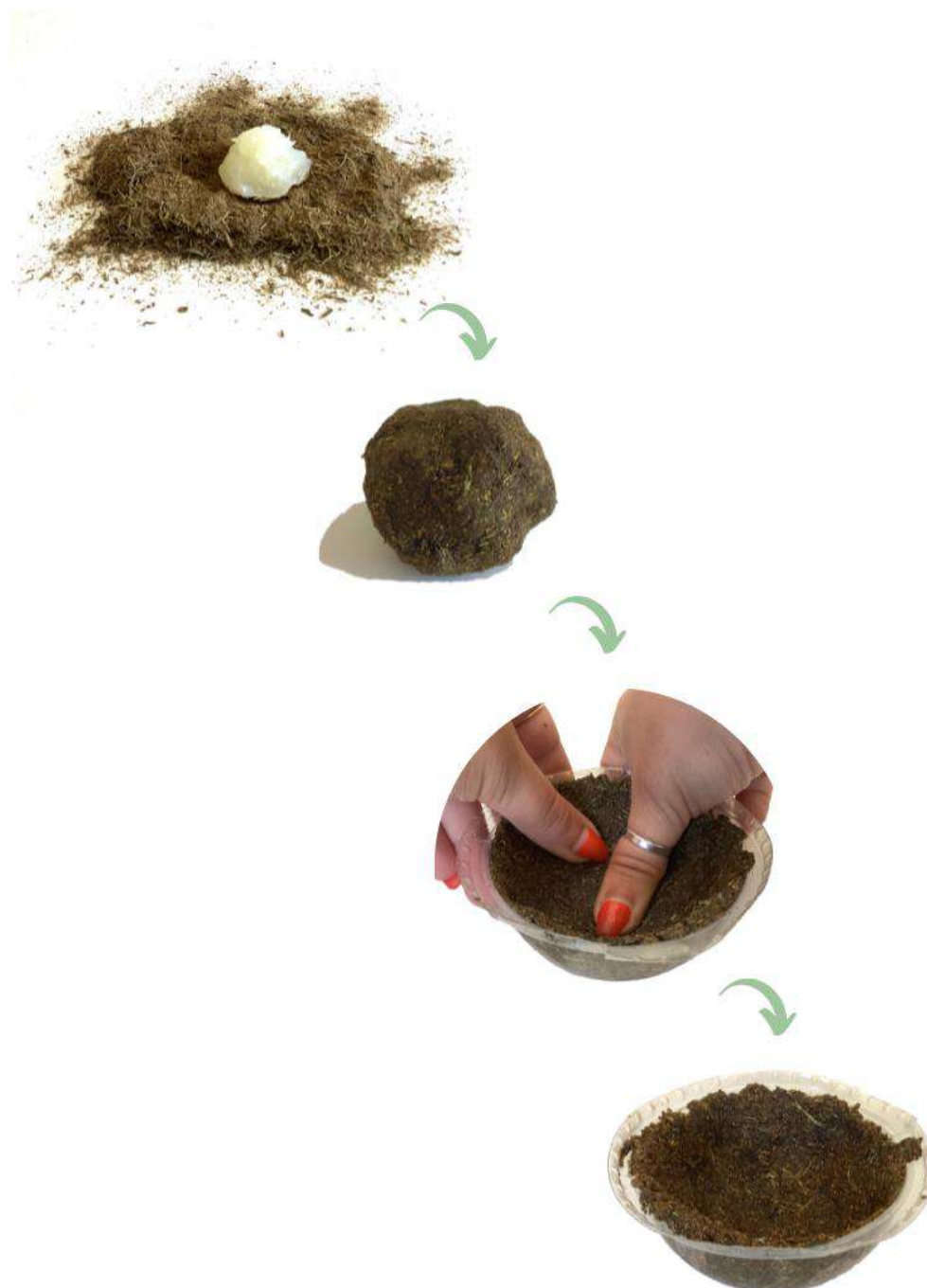
Fig. 60- representação de cada etapa realizada no processo para obtenção do material #1, da mistura das duas componentes principais (receita base e fibras naturais) até à moldação da matéria-prima final.
