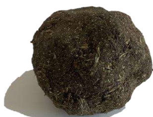
Fig. 59- resultado da envoltória das fibras com a mistura resultante
