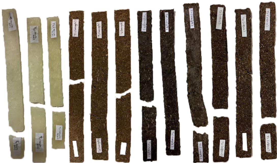
Fig. 110- provetes depois do ensaio à tração - receita base, beringela, curgete e alface, respetivamente.
