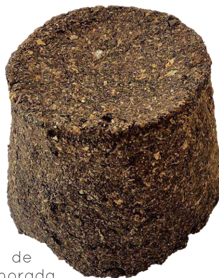
Fig. 70- visualização do material com matriz uniforme e sem fissuras (vista inferior)
