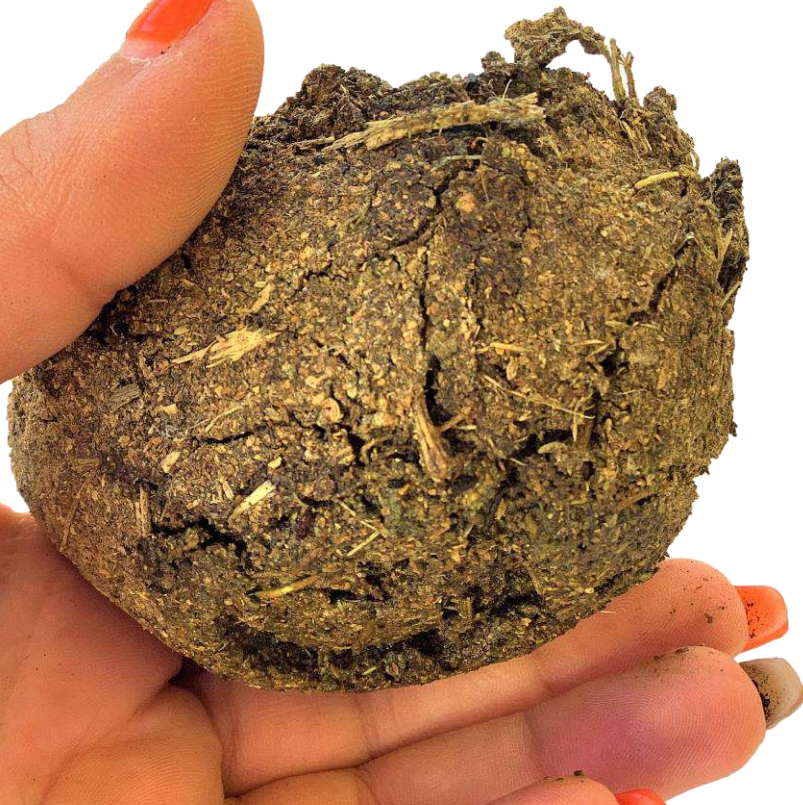
Fig. 62- visualização da pouca integridade obtida na estrutura do compósito
