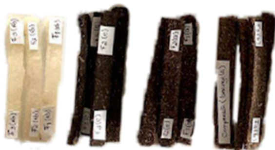
Fig. 114- provetes realizados para ensaio de flexão
