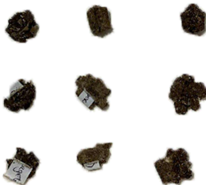
Fig. 118- provetes depois do ensaio de compressão - curgete, beringela e alface, respetivamente.
