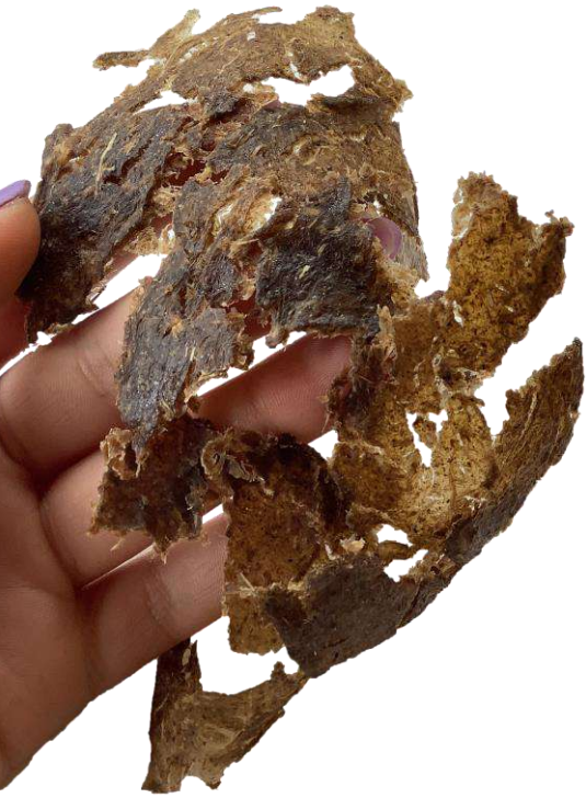
Fig. 37- amostra resultante da receita base #1 com fibras trituradas de curgete semi-seca.
