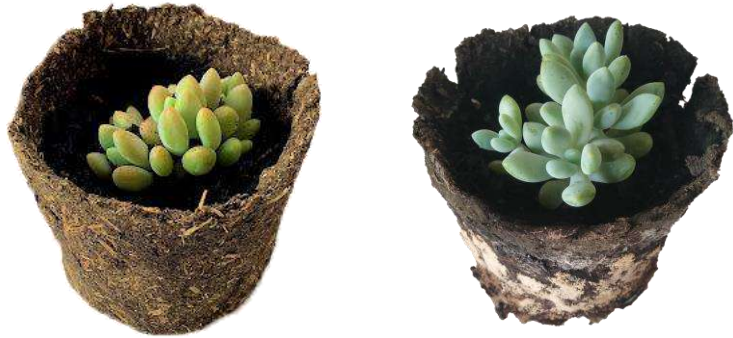
Fig. 100- processo de deterioração do vaso com maior percentagem de amido de milho, da esquerda para a direita
