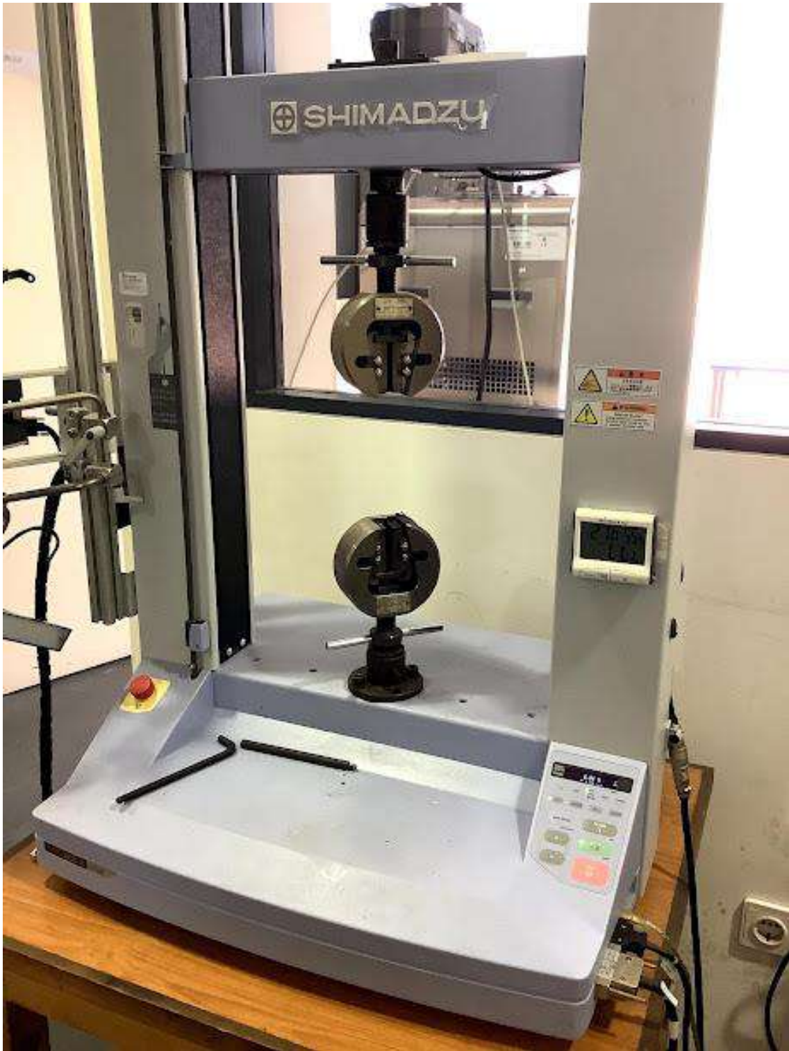
Fig. 108- máquina de teste - Shimadzu- com amarras para o ensaio de tração (velocidade de 2mm/min)
