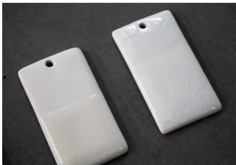
Figura 161 - Ensaios 24 e 25, com vidro e casca de ovo (4h de moagem).
