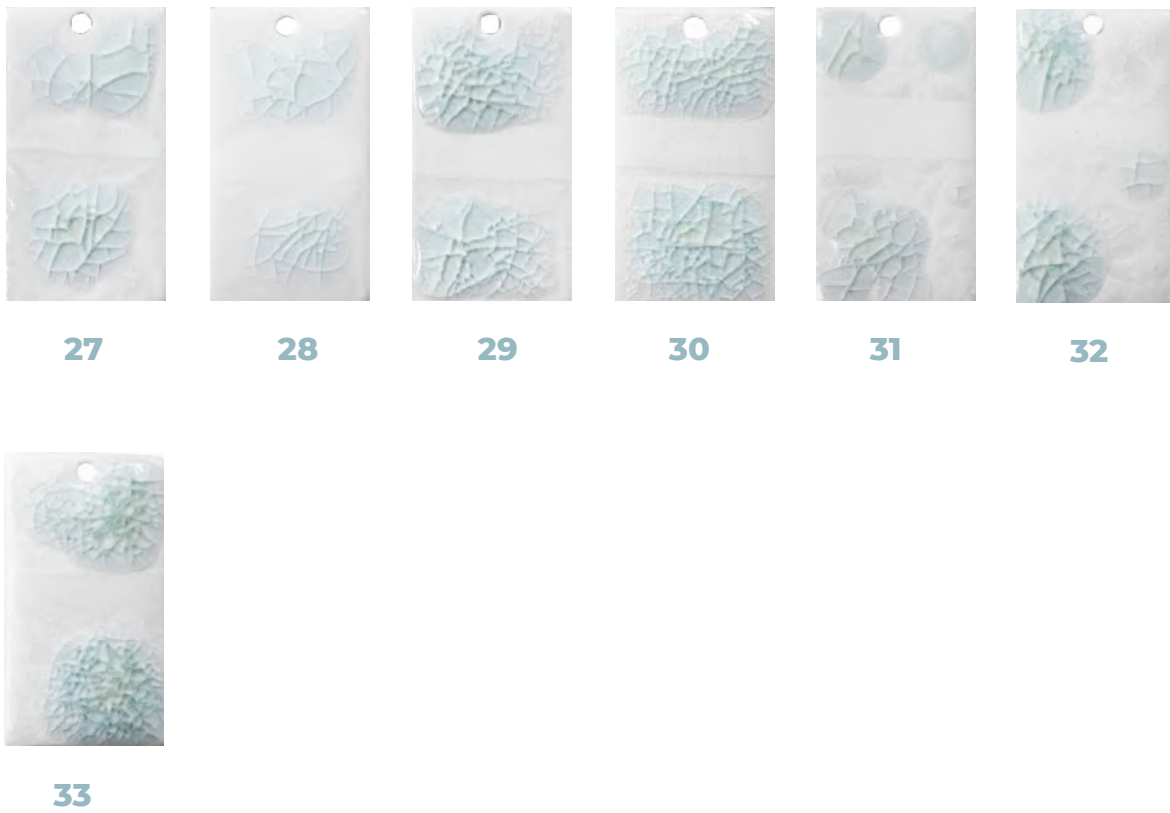
Figura 160 - Ensaios com vidro e casca (4h de moagem) - forno de vidro II.
