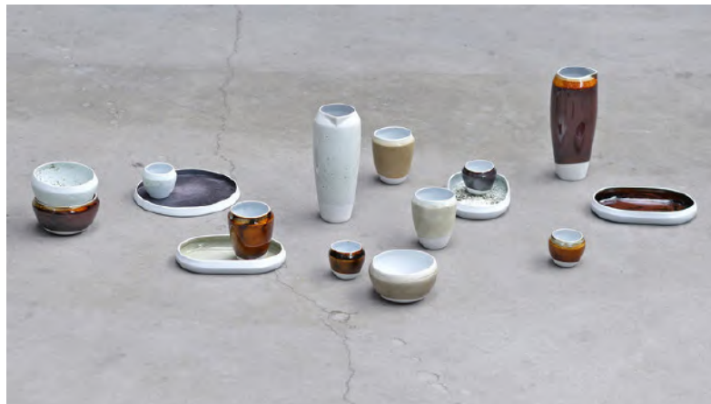
Figura 68 - Somatório das peças vidradas com resíduos metálicos.
