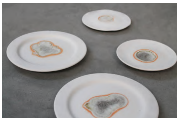
Figura 136 - Ensaio pós-cozedura das matérias-primas naturais com diferentes solventes II.
