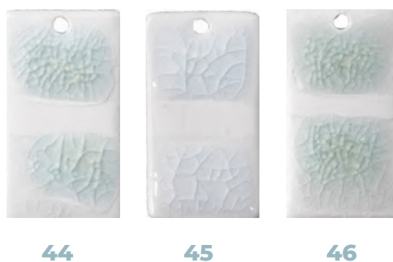
Figura 163 - Ensaio com vidrado e casca (8h de moagem a húmido) - forno de vidrado.
