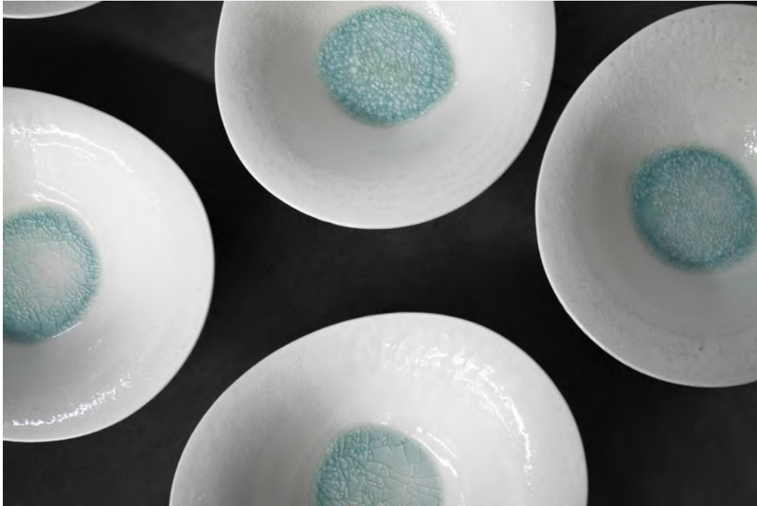
Figura 185 - Variações da intensidade da cor azul; saladeiras vidradas com 50 % de casca e 50 % de vidrado.
