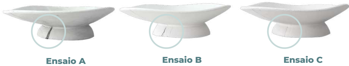
Figura 108 - Grau de deformação dos ensaios da taça Pegasus com 2h de tempo de repouso.
