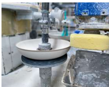
Figura 28 - Acabamento automatizado de peças por prensagem isostática.
