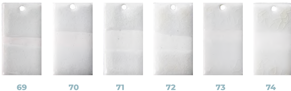
Figura 166 - Ensaio com vidrado, casca (6h de moagem) e beterraba (em meio ácido) - forno de vidrado.
