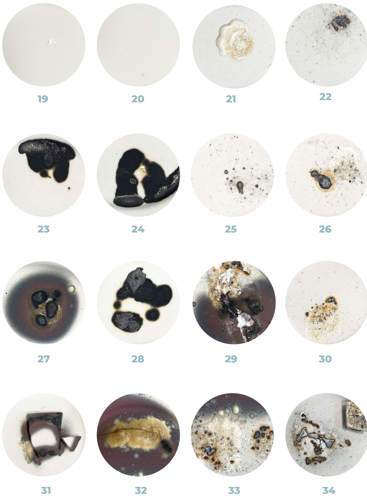
Figura 132 - Resultados dos ensaios da borra de café e adição de outros materiais no forno de vidro.
