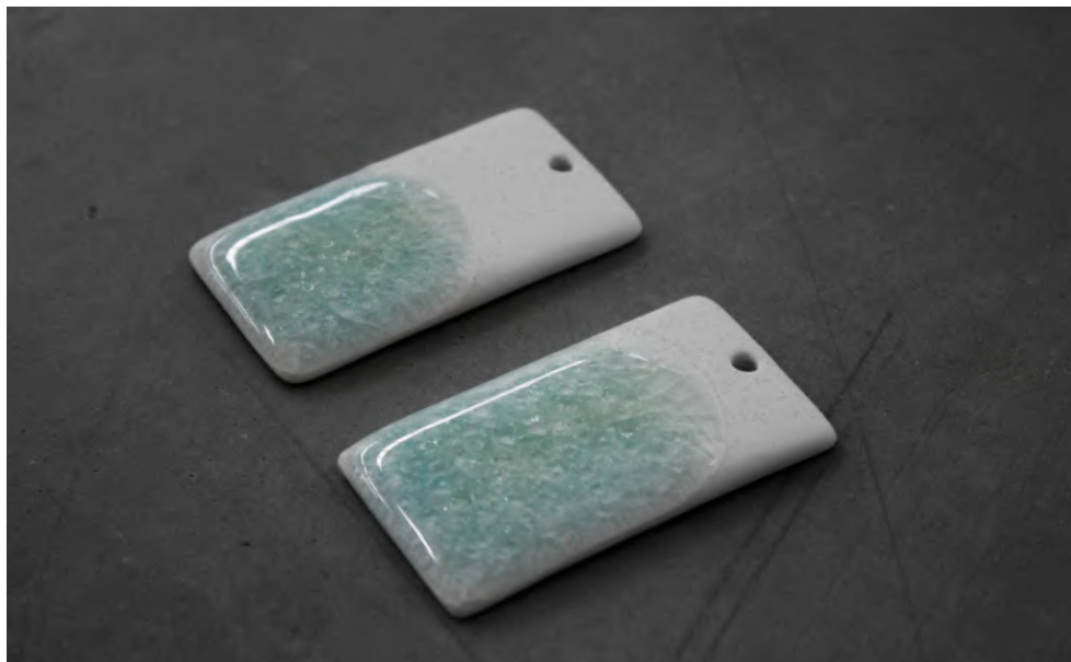
Figura 151 - Texturas produzidas com casca de ovo integrada no vidro.
