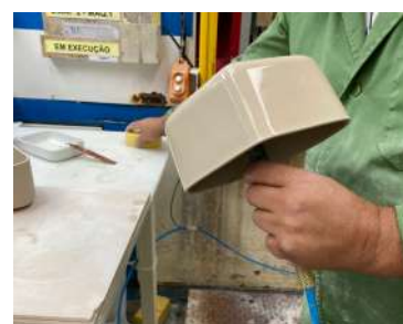
Figura 25 - Peças retiradas por enchimento por alta pressão.
