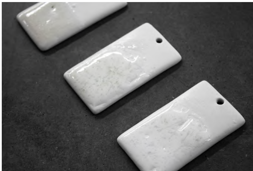
Figura 157 - Detalhes da textura obtida com casca de ovo integrada no vidrado (ensaio 3 e 4).
