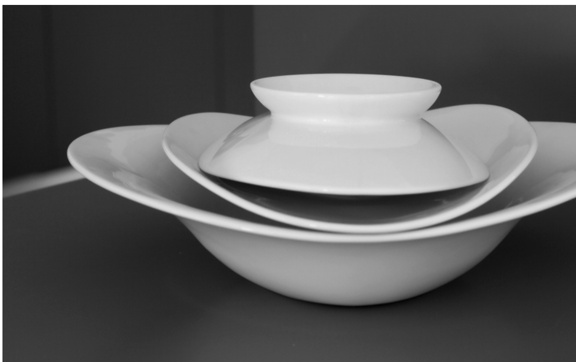
Figura 115 - Conjunto Pegasus vidrado; grau de deformação das peças após cozedura.
