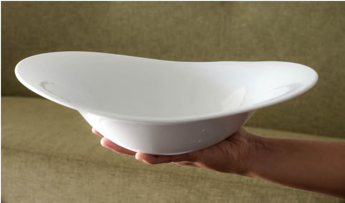
Figura 124 - Deformação da saladeira Pegasus - alongamento da forma no eixo x e diminuição da acentuação da curva central da peça.
