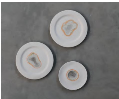
Figura 135 - Ensaio pós-cozedura de matérias-primas naturais com diferentes solventes.
