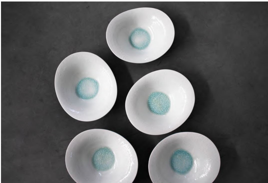
Figura 182 - Diferentes resultados obtidos com 50 % de casca e 50 % de vidrado.
