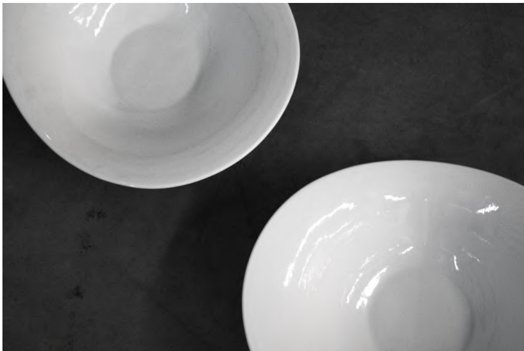
Figura 183 - Saladeiras Pegasus vidradas com 10 % de casca e 90 % vidrado.
