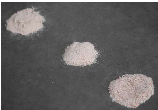
Figura 153 - Diferentes granulometrias aplicadas nos ensaios da casca de ovo com vidro.
