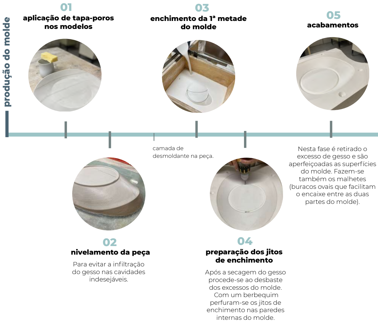
Figura 95 - Etapas de concretização do molde do prato Pegasus.
