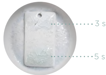
Figura 156 - Tempos de mergulho, ensaio 5 (1h de moagem).
