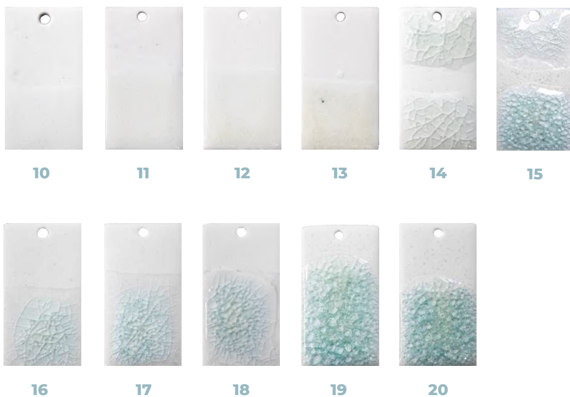
Figura 158 - Ensaio com vidrado e casca (2h de moagem) - forno de vidrado.
