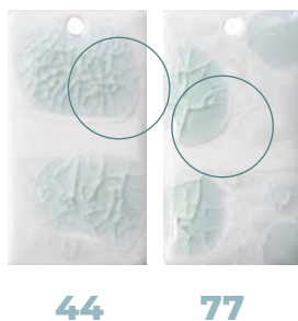
Figura 169 - Ensaios 44 e 77, vidro rachado assinalado a azul.
