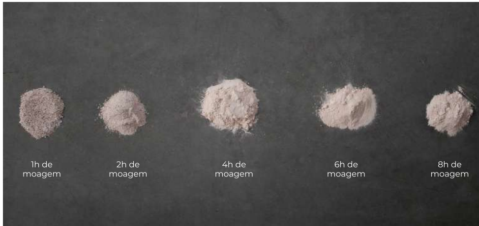
Figura 152 - Diferentes horas de moagem da casca de ovo.
