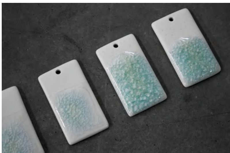
Figura 149 - Resultados dos ensaios com casca de ovo e vidrado II
