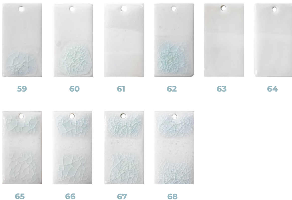
Figura 165 - Ensaio com vidrado, casca (4h de moagem) e beterraba (em diferentes estados) - forno de vidrado II.
