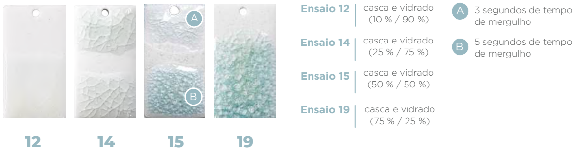
Figura 168 - Diferentes tonalidades obtidas, face à intensidade de casca no vidro e tempo de mergulho.
