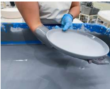
Figura 31 - Processo de vidragem por mergulho.
