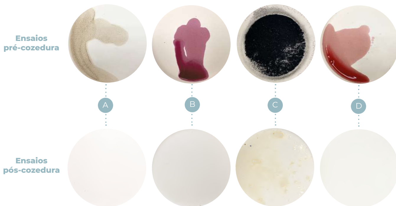
Figura 144 - Ensaio no forno de vidro; (A) beterraba líquida em meio básico (adição de água e bicarbonato de sódio); (B) beterraba líquida em meio ácido (adição de vinagre branco); (C) beterraba incinerada a 300°C; (D) líquido do pigmento de beterraba extraído com etanol.
