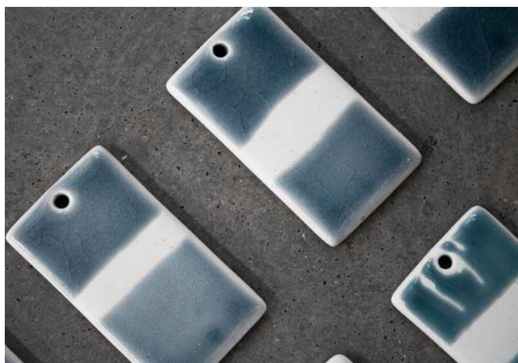
Figura 170 - Ensaios com vidrado, casca de ovo (6h de moagem) e corante sintético azul.
