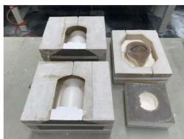
Figura 16 - Madre de Araldite para olaria, constituída por 4 partes.
