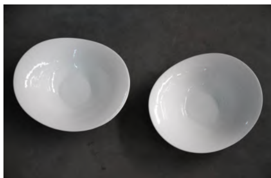
Figura 120 - Deformação da forma circular da saladeira Pegasus.
