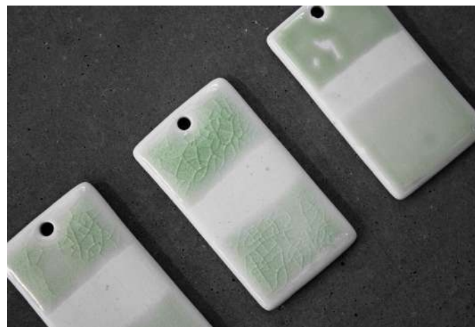
Figura 172 - Ensaio com vidro, casca de ovo (6h de moagem) e corante sintético verde.
