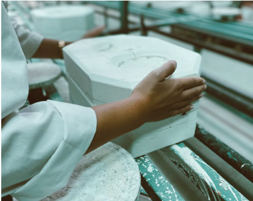
Figura 100 - Processo de desmoldagem.
