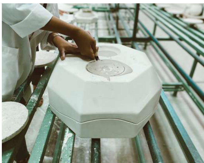
Figura 99 - Desbaste do excesso de pasta nos jitos de enchimento.
