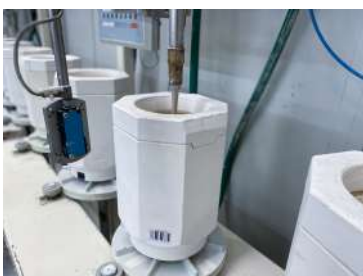
Figura 23 - Conformação por enchimento semiautomático.
