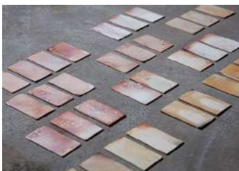
Figura 64 - Ensaios dos vidrados com borra de café.
