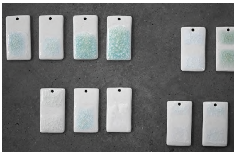
Figura 148 - Resultados dos ensaios com casca de ovo e vidrado.
