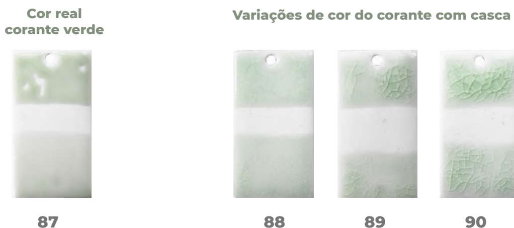
Figura 173 - Ensaios com vidrado e corante verde / variações da cor do corante com casca de ovo.
