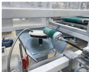
Figura 29 - Sensores que detetam as zonas a rebarbar.
