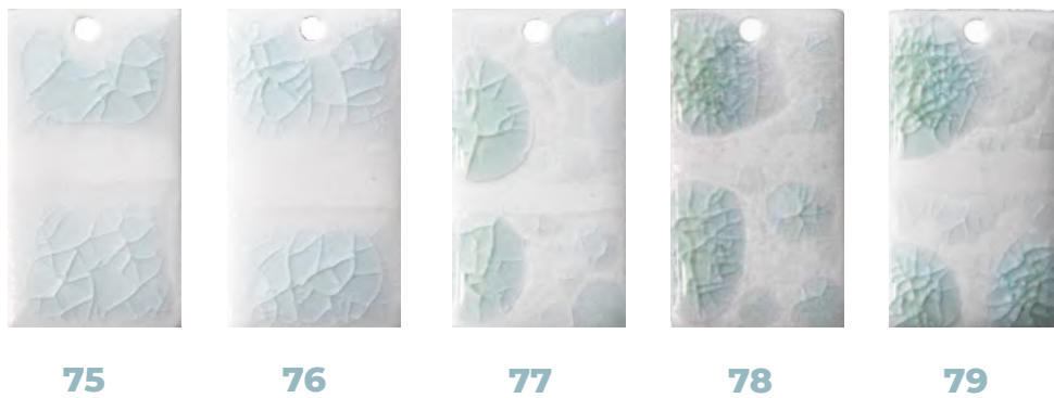
Figura 167 - Ensaios com vidro, casca (6h de moagem) e beterraba (em meio ácido) - forno de vidro II.
