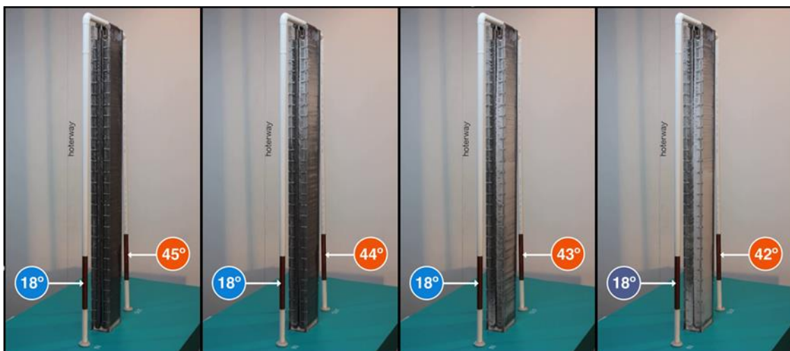
Figura 16 - Processo de descarga de uma bateria hoterway - bateria de demonstração
