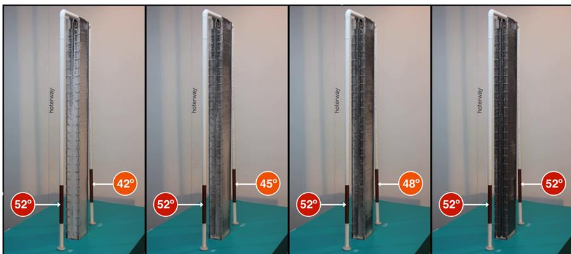
Figura 17 - Processo de carga de uma bateria Hoterway - bateria de demonstração
