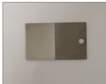
Figura 3.14 – Chapa com transição para medição de espessura
