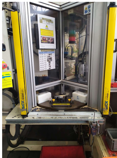
Figura 2.6: Local de colocação de peças para cravamento
