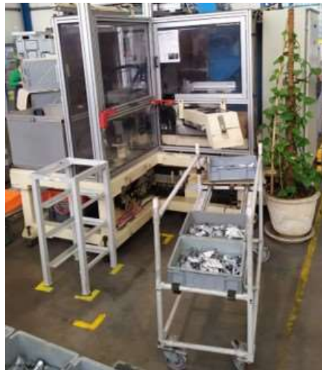
Figura 2.10: Máquina de cravação - Local de saída de peças
