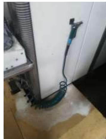
Figura 4.4- Fotografia ilustrativa de uma pistola de óleo de corte sem suporte a verter óleo.
