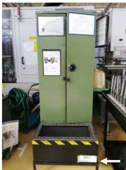
Figura 4.16- Fotografia ilustrativa de um armário dos óleos, com retenção (250L) (↑).
