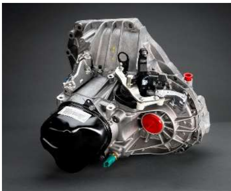
Figura 2.3- Caixa de Velocidades JR.
