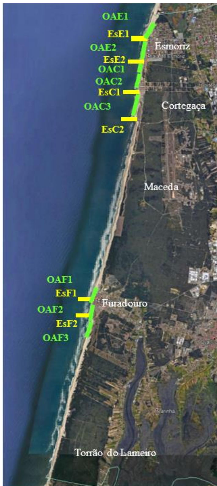
Figura 2.1 - Localização das obras de defesa costeira (esporões – Es e obras longitudinais aderentes – OA de Esmoriz – E, Cortegaça – C e Furadouro – F) (adaptado de Google Earth, 2020)
