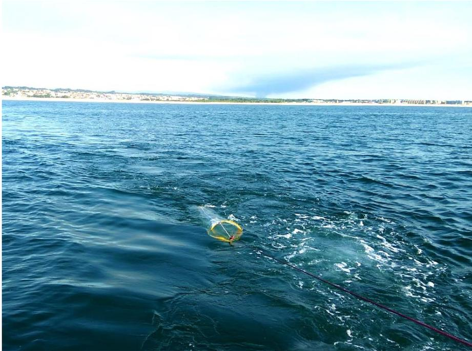
**Figura 6.** Arrasto da camada superior da coluna de água com rede de plâncton.
