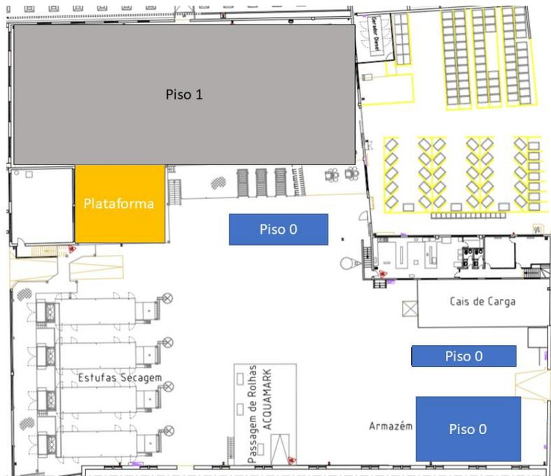
Figura 18 - Planta paletização por pisos
