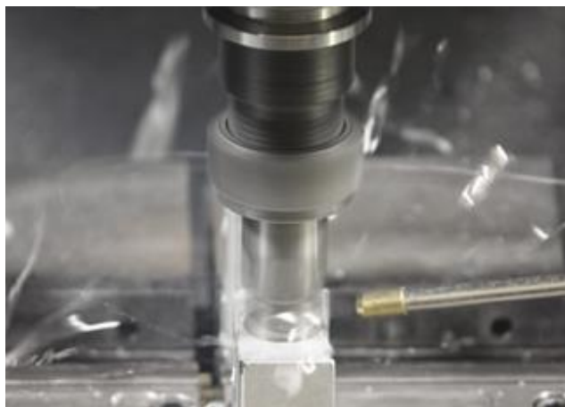
Figura 2.2: Sistema MQL externo Unist, utilizado numa operação de fresagem (Richter, 2015).
