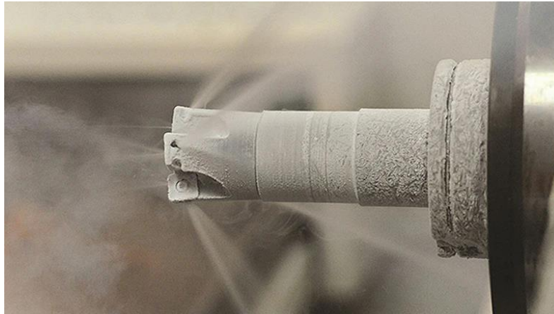
Figura 2.6: Refrigeração criogénica utilizando LN 2 (Brooks, 2015).
