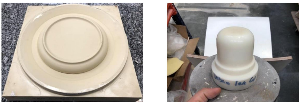
Figura 3.11 -Madre de poliuretano, à esquerda, e calibrador em nylon, à direita, produzidos pelo método apresentado por Maruccio et al. [24].
