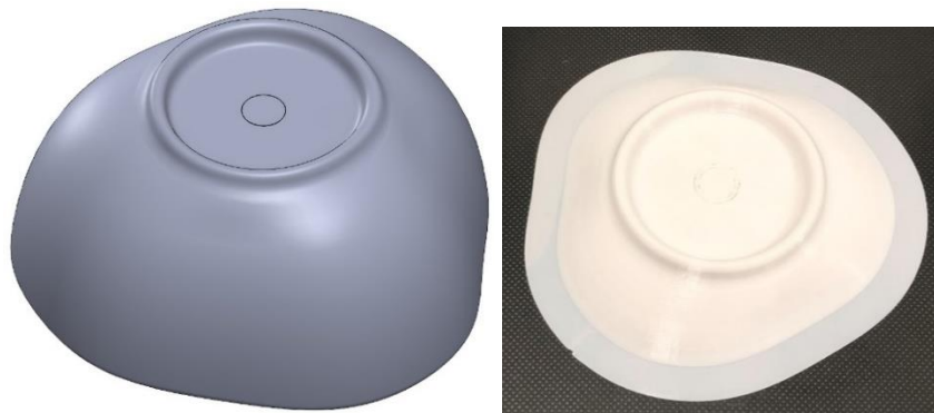
Figura 4.19 – CAD da tigela com um frete circular, à esquerda, e impressão 3D de parte da mesma, à direita.
