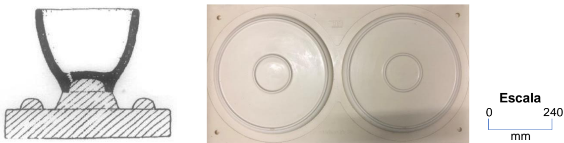
Figura 4.3 – Exemplo de um molde cuja zona do frete não permite a contração da peça [25], à esquerda, e de uma mãe com um frete intermédio, à direita.
