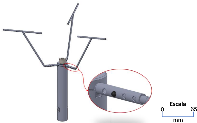
Figura 6.3 – Spindle de dimensão ajustável cujo sistema de ajuste foi baseado no utilizado nas canadianas.
