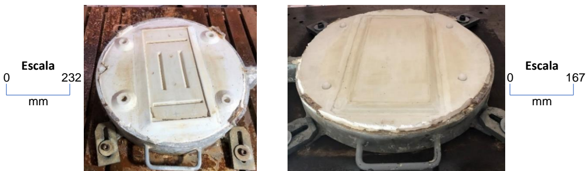
Figura 5.15 – Moldes para a prensagem RAM da travessa do projeto, obtidos pelo método tradicional.
