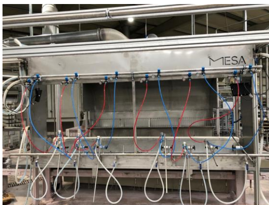
Figura 3.18 - Estação de vidragem automática, à esquerda, e tapete de esponja humedecida, à direita.
