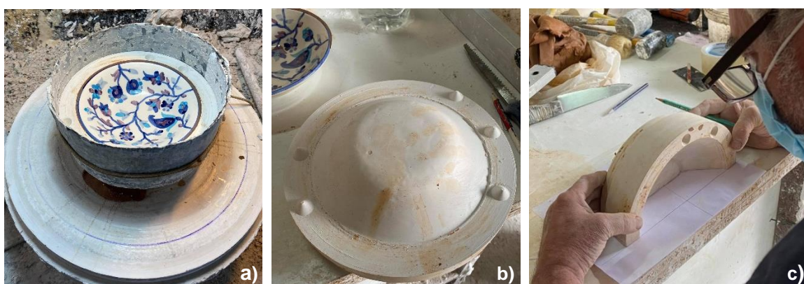
Figura 4.5 – a) Montagem de um recetáculo para obtenção do molde do lado oposto da peça; b) molde do lado oposto da peça obtido e c) desenho manual do calibrador a partir do primeiro molde.
