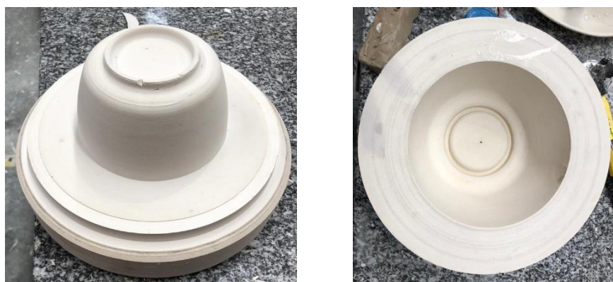
Figura 3.8 – Madre de gesso, à esquerda, e primeiro molde de gesso, à direita, fabricadas pelo método tradicional.
