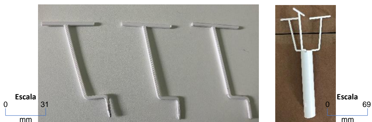
Figura 6.7 – Impressão 3D das hastes de dimensão S projetadas através de ferramentas CAD , à esquerda, e montagem das mesmas na estrutura já impressa, à direita.
