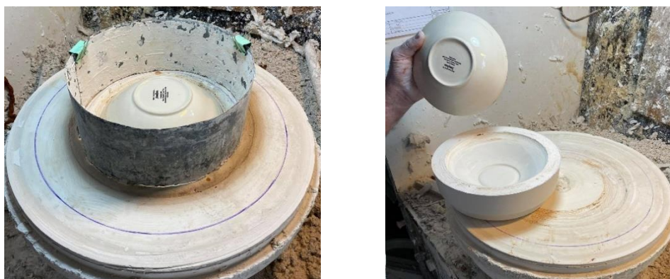
Figura 4.4 – Montagem de um recetáculo metálico, à esquerda, e primeiro molde obtido, à direita.
