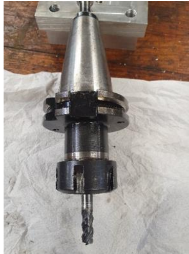
Figura 6.3 - Fresa de Metal Duro de Ø8 mm (Nº2). Cortesia: IEFP Águeda.
