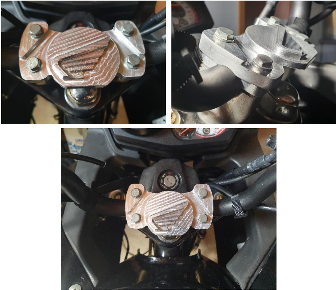
Figura 7.2 - Montagem do protótipo com o sistema de fixação do guidador.
