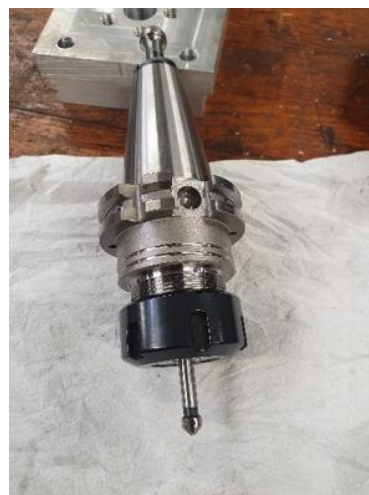
Figura 6.6 - Escareador Ø8 mm (Nº5). Cortesia: IEFP Águeda.
