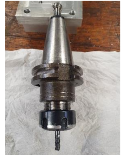
Figura 6.4 - Fresa de Metal Duro de Ø6 mm (Nº3). Cortesia: IEFP Águeda.
