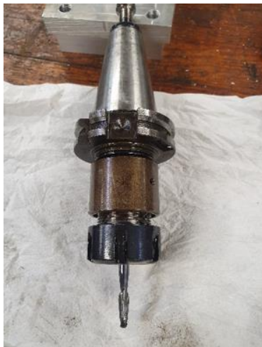
Figura 6.5 - Fresa de Metal Duro (topo esférico) de Ø6 mm (Nº4). Cortesia: IEFP Águeda.
