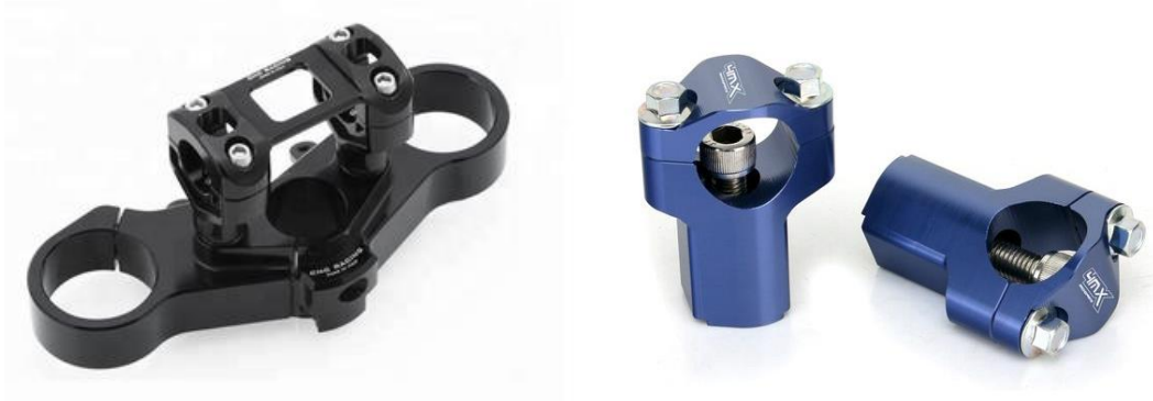
Figura 3.9 - Exemplo de um conjunto de mesa de direção superior com a mesa de aperto de guidador [37][38].
