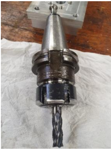
Figura 6.2 - Fresa de Metal Duro de Ø12 mm (Nº1). Cortesia: IEFP Águeda.
