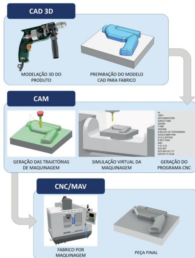
Figura 2.5 - Principais fases de um processo de CAD/CAM [5].
