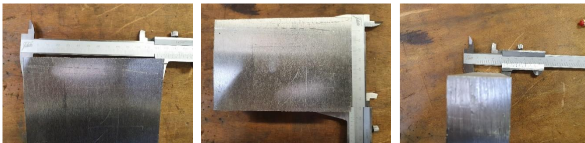
Figura 6.8 - Processo de medição das dimensões do bloco em bruto utilizado.
