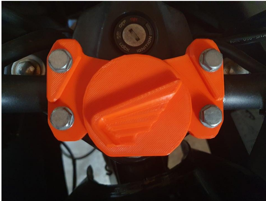
Figura 4.12 - Fotografia do protótipo obtido por impressão 3D e respetiva montagem com o restante sistema de aperto.
