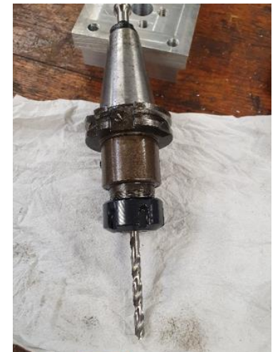
Figura 6.7 - Broca Helicoidal HSS Ø6,5 mm (Nº6). Cortesia: IEFP Águeda.
