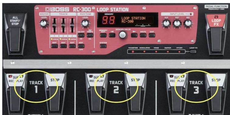
Figura 39. Três Faixas de Gravação (Tracks) da RC-300
