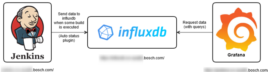
Figura 6.5: Arquitetura do fluxo de dados para dashboard com o estado de cada build no Jenkins
