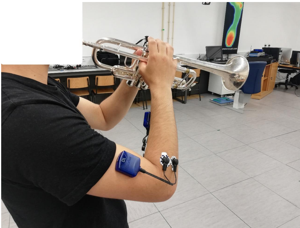
Figura 12 - Demonstração da colocação dos Eléctrodos nos extensores da mão direita
