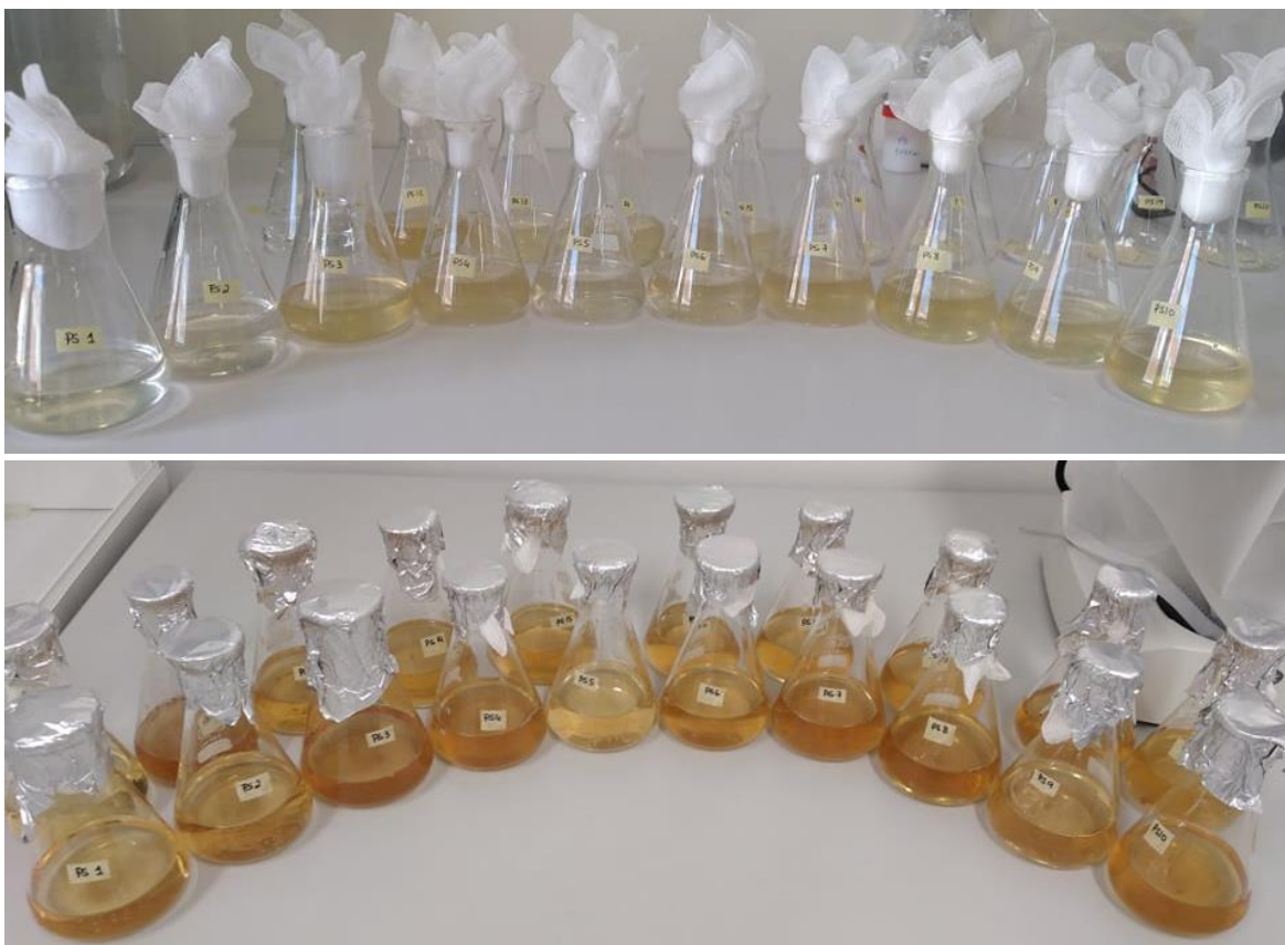
Figura 16. Experiência de otimização do PS. Erlenmeyers com meio de cultura antes (imagem superior) e após (imagem inferior) a autoclavagem.
