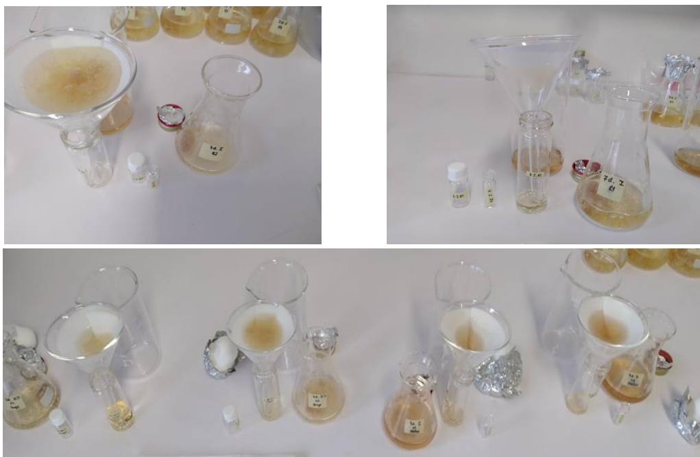
Figura 14. Filtração dos meios de cultura, fungos e microplásticos.
