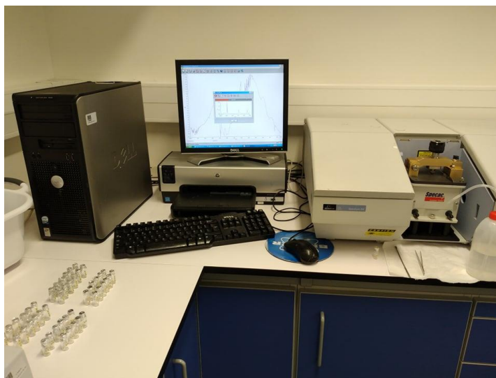
Figura 17. Análise de amostras de plásticos no FTIR-ATR.
