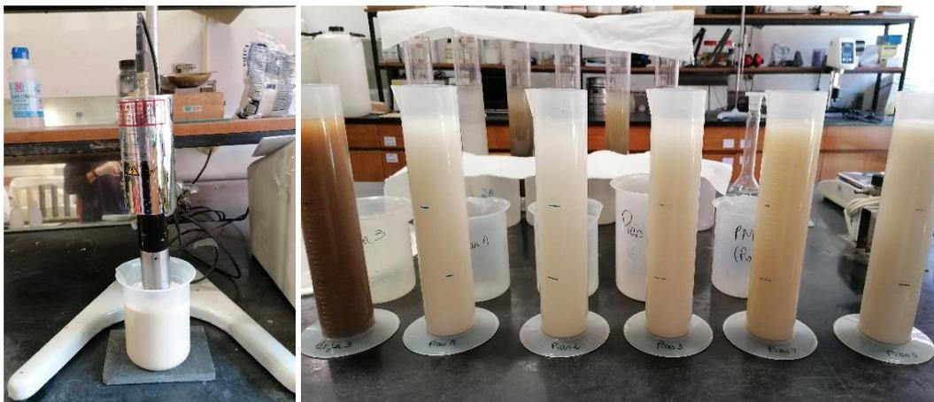
Figura 24 - Separação por sedimentação - Lei de Stokes.
