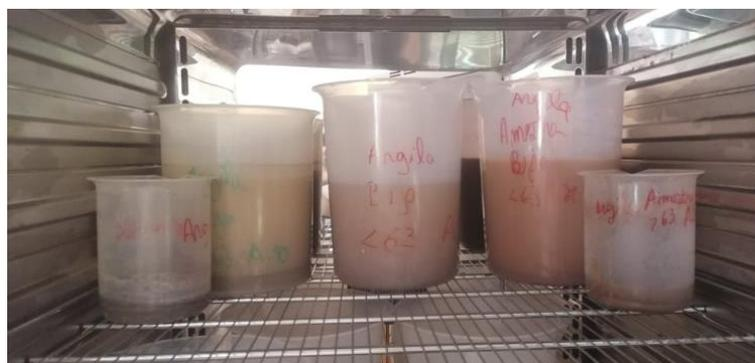
Figura 23 - Amostras colocadas numa estufa a 40 °C.
