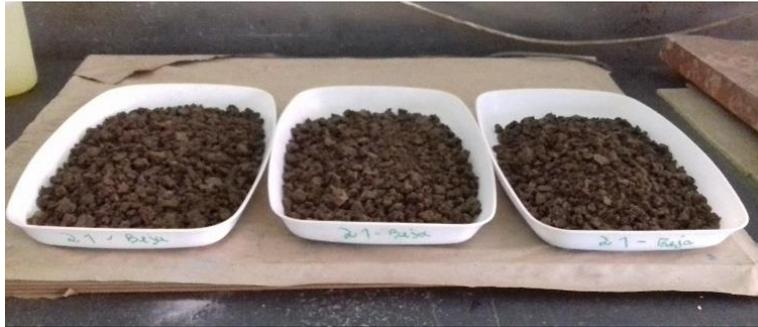
Figura 20 - Amostras colocadas em tabuleiros para serem secas a 40 °C numa estufa.
