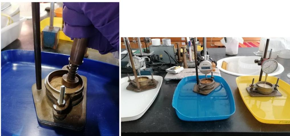
Figura 36 - Ensaio de expansibilidade nas amostras estudadas.
