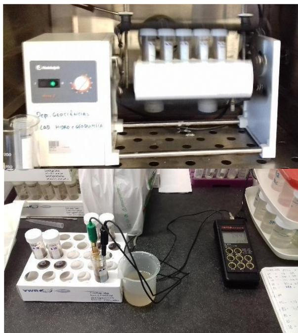
Figura 26 - Agitação e medição do pH.
