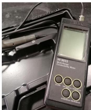
Figura 27 - Condutímetro Multi Range - HI 9033.
