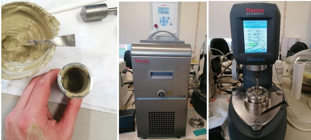
Figura 40 - Determinação da viscosidade através de um viscosímetro.
