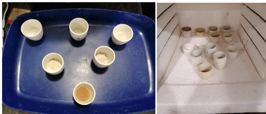
Figura 28 - Cadinhos colocados na mufla para eliminar a matéria orgânica.
