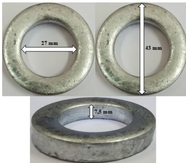
Figura 27 – Anel de metal não corrosivo e respectivas dimensões.
