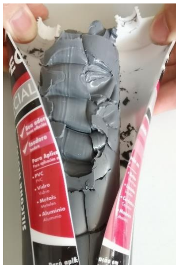
Figura 34 – Demonstração da existência de bolhas de ar no interior do cartucho.
