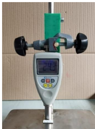
Figura 20 – Demonstração do sistema do teste de dureza e do valor da calibração do aparelho.
