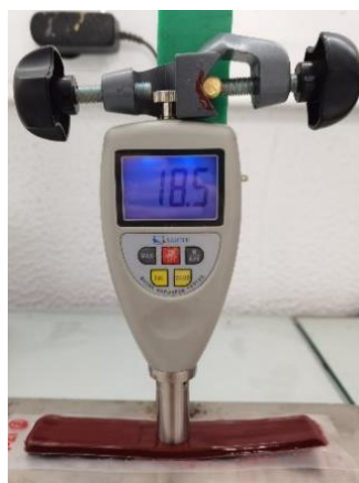
Figura 22 – Demonstração da utilização do durómetro num filme de silicone acético bordô.
