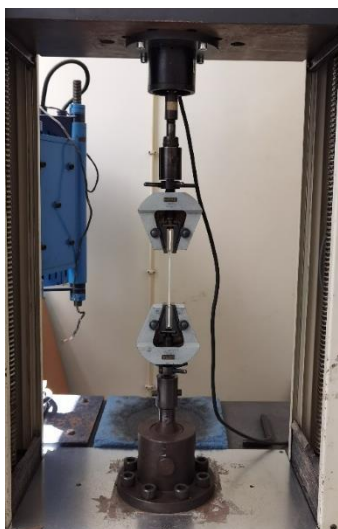
Figura 18 – Demonstração de um provete preso nas garras da máquina pronto a ser alongado.
