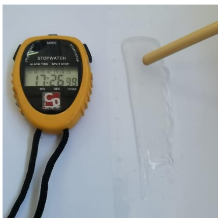
Figura 26 – Demonstração do método de verificação do tempo de formação de película num filme de SA.
