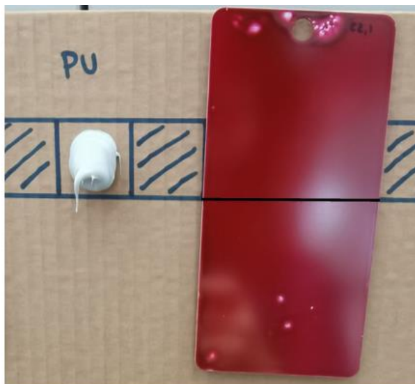
Figura 29 – Cartão utilizado no teste de escorrimento para o SA PU.
