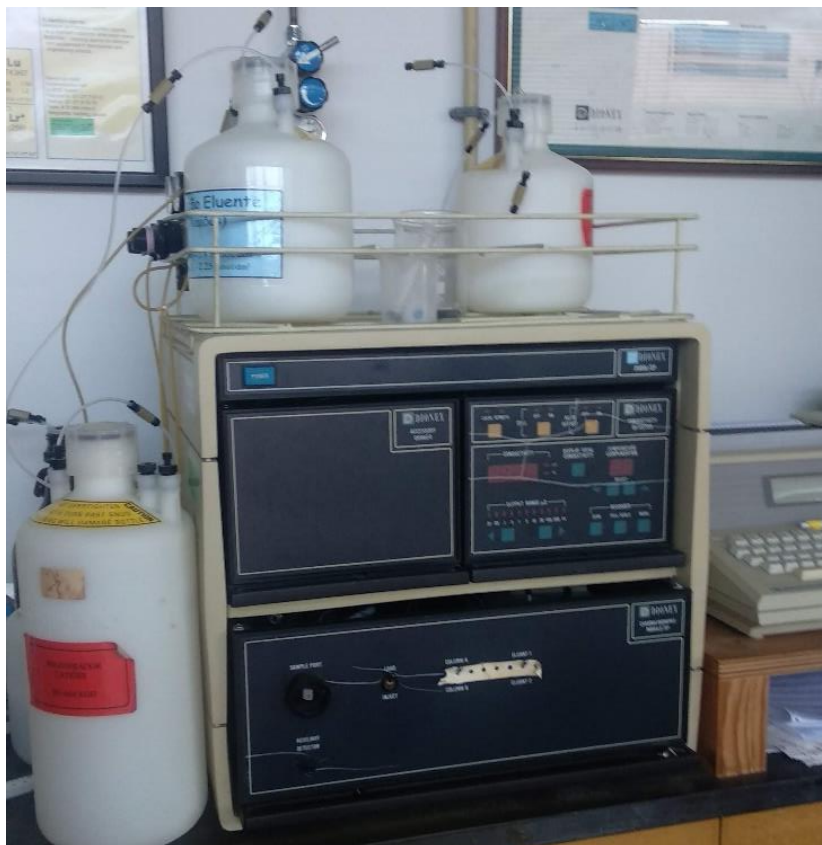
Figura 3.5. Cromatógrafo iônico usado na análise aniônica das águas.
