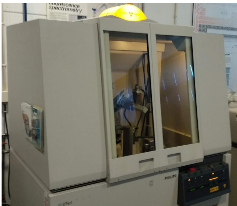
Figura 3.8. Difractómetro de raios-X usado na determinação mineralógica das amostras de sedimentos.
