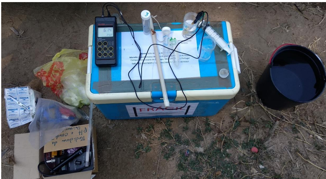
Figura 3.3. Medição ( in situ ) dos parâmetros físico-químicos e determinação da concentração de bicarbonatos das águas por titulação.
