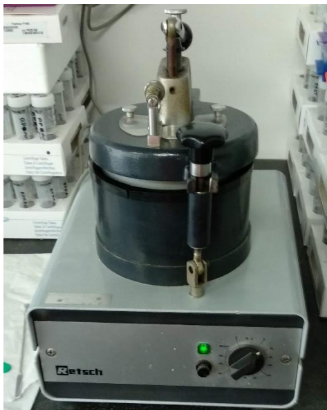
Figura 3.7. Moinho de ágata com panela rotativa usado na moagem das amostras de sedimentos.
