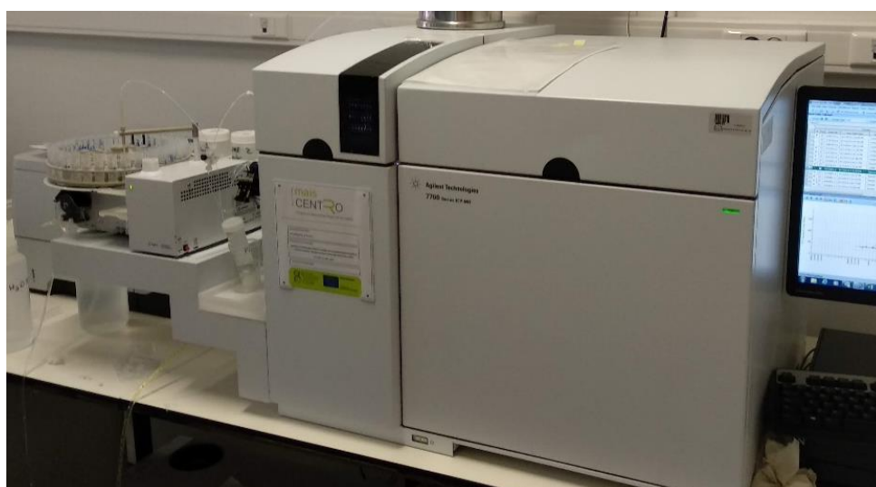
Figura 3.6. Espectrómetro de massa por plasma acoplado indutivamente usado na análise catiônica das águas.
