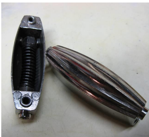
Figura 22: Spring tension lug . O spring é uma pequena peça que se encontra dentro do lug .
